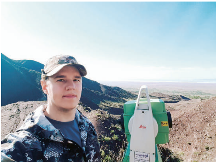
Иран, июнь 2017 года. Недалеко от города Чешмеконан. Александр производит тахеометрическую съёмку забоев на приборе Leica TS 02
