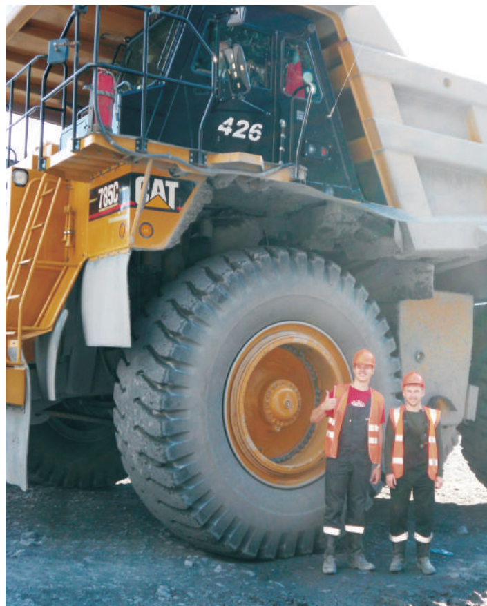
Красноярский край, Олимпиадинский ГОК, карьер Восточный, где Александр был на практике по окончании 3 курса. «После маркшейдерской съёмки и уточнения контуров выемки экскаватор забирает породу и грузит её в такие вот 90-тонные самосвалы», – рассказывает он
