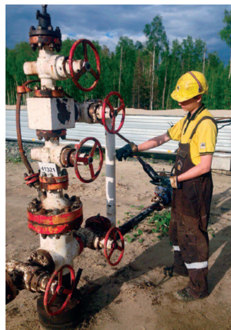
Ян Жичко отбирает пробы флюида (жидкости различного состава) на содержание воды. По наличию количества воды, говорит будущий геолог, определяют степень обводненности скважины
