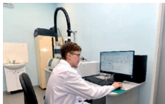
Прибор синхронного термического анализа модели STA 449 F5 Jupiter, совмещенный с масс-спектрометром
