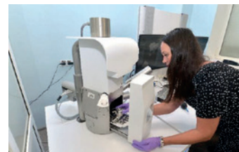
Электронный сканирующий микроскоп VEGA LMS TESCAN с приставкой для энергодисперсионного анализа
