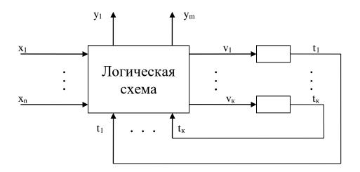
Рис. 6.2. Структурная схема автомата Мили
