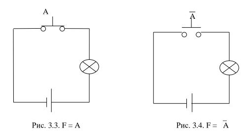
Если высказывание **A** интерпретировать как «реле разомкнуто», то будет справедливо  $\mathbf{F} = \overline{\mathbf{A}}$ . Соответствующая F схема приведена на рис. 3.4.
