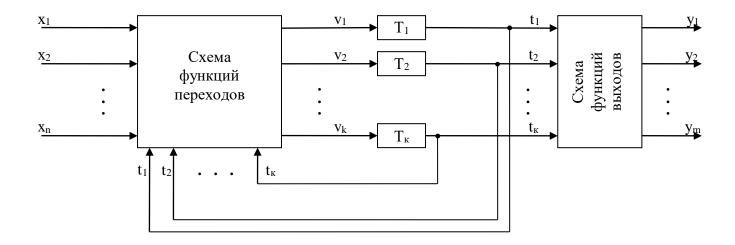
Рис. 6.3. Структурная схема автомата Мура
