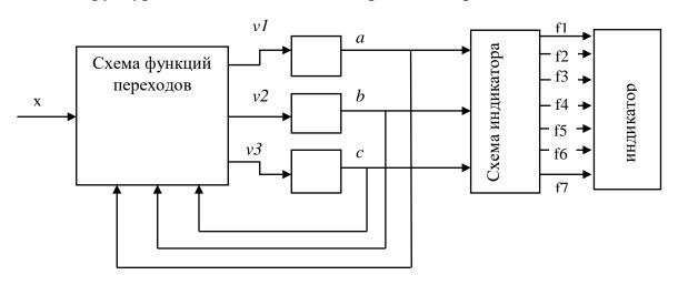
Рис. 6.8. Структурная схема счетчика
