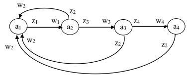
Рис. 5.3 Автомат, описывающий функционирование ATC
