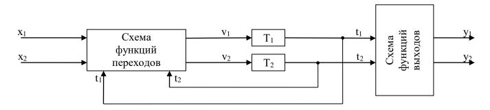
Рис. 6.5. Схема структурного автомата Мура
