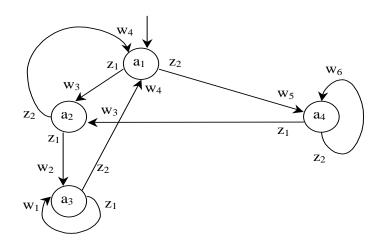
Рис. 5.2 Автомат, описывающий поведение «умного» отца
