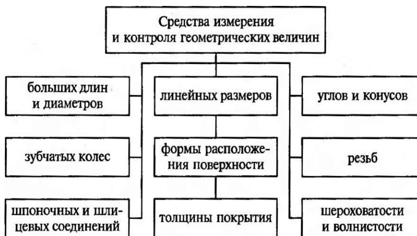
Рис. 2. Классификация средств измерения и контроля по виду измеряемых
