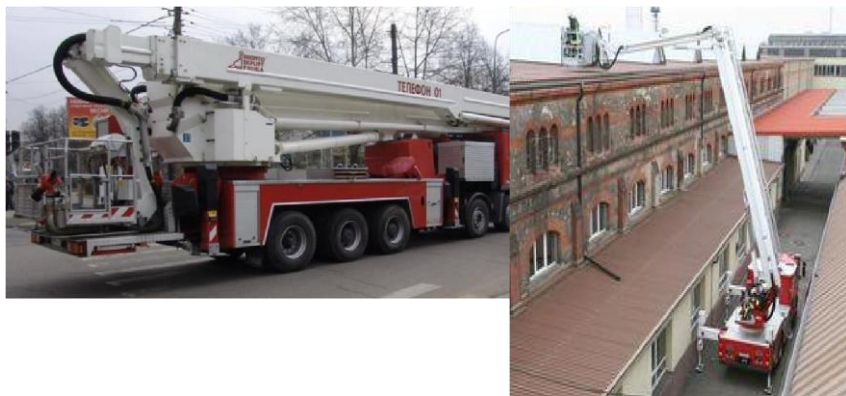
Рис.78 Автоподъемники. Общий вид и вид с разложенной стрелой
