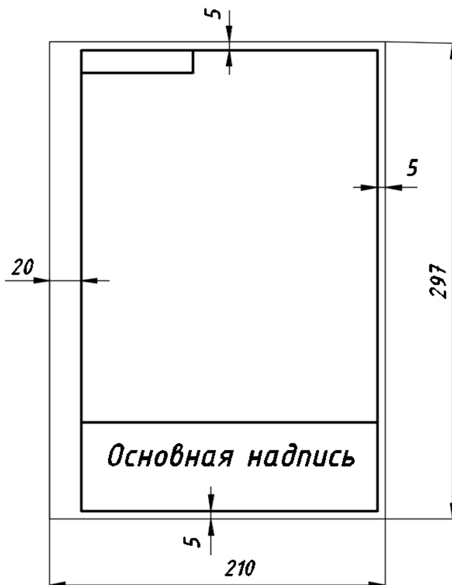
Рис. 3. Расположение основной надписи на формате А4
