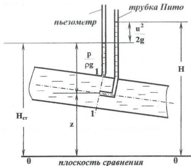
Рис.1.1. Экспериментальное определение статического, полного и скоростного напоров
