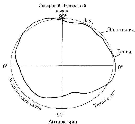
Рис. 2. Меридиональное сечение геоида и земного эллипсоида
