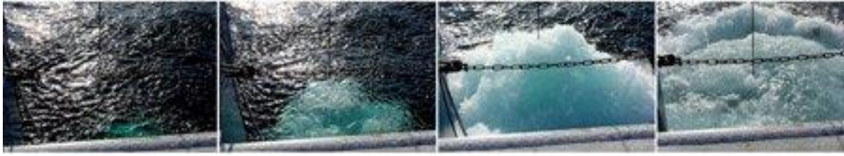
Рис.2 Воздушный пузырь из пушки 600 \text{ in}^3 на глубине 3 м. Выхлоп воздуха создает ударную волну с крутым фронтом, которая наблюдается в виде ряби на поверхности моря (кадры 1 и 2), прежде чем пузырь вырвется на поверхность (кадры 3 и 4)
