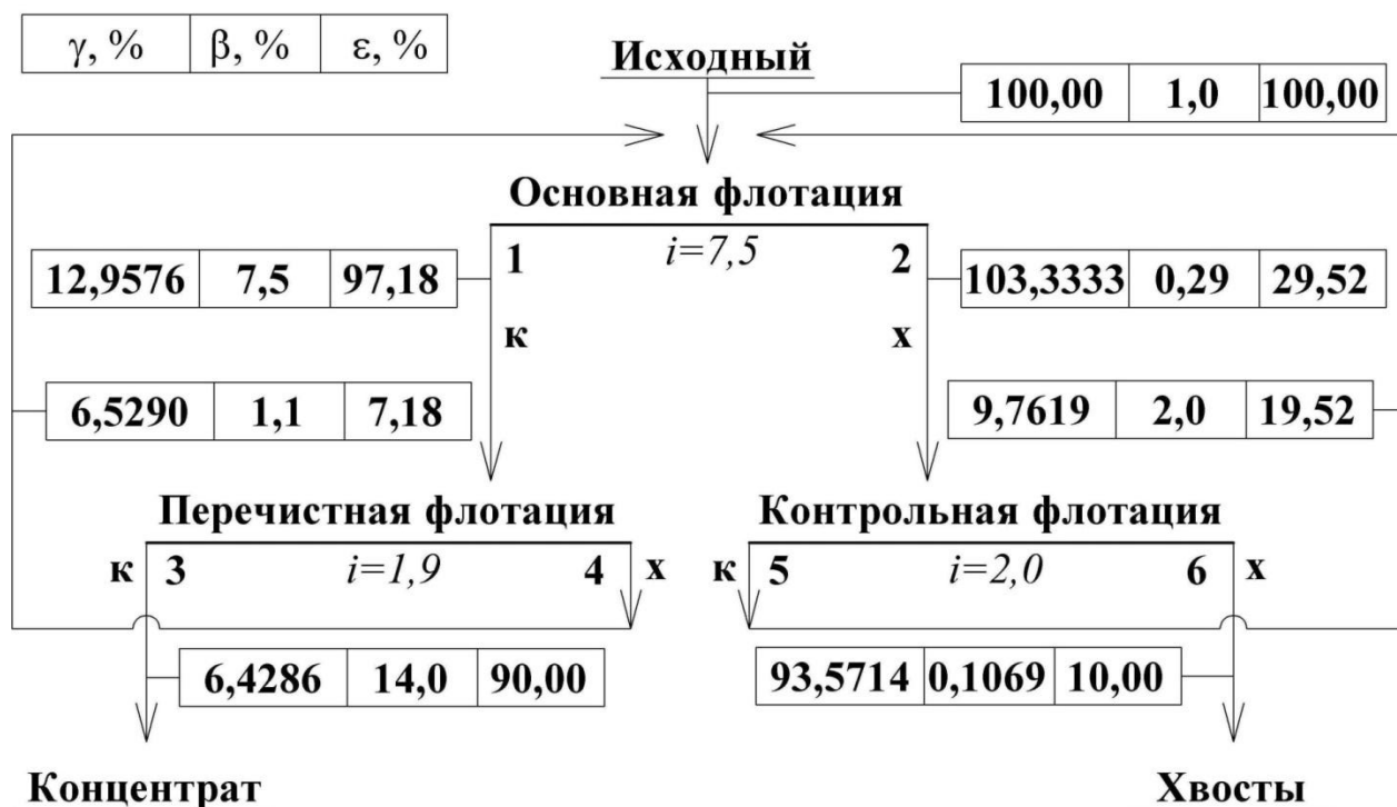
Рис. 6. Качественно-количественная схема обогащения
