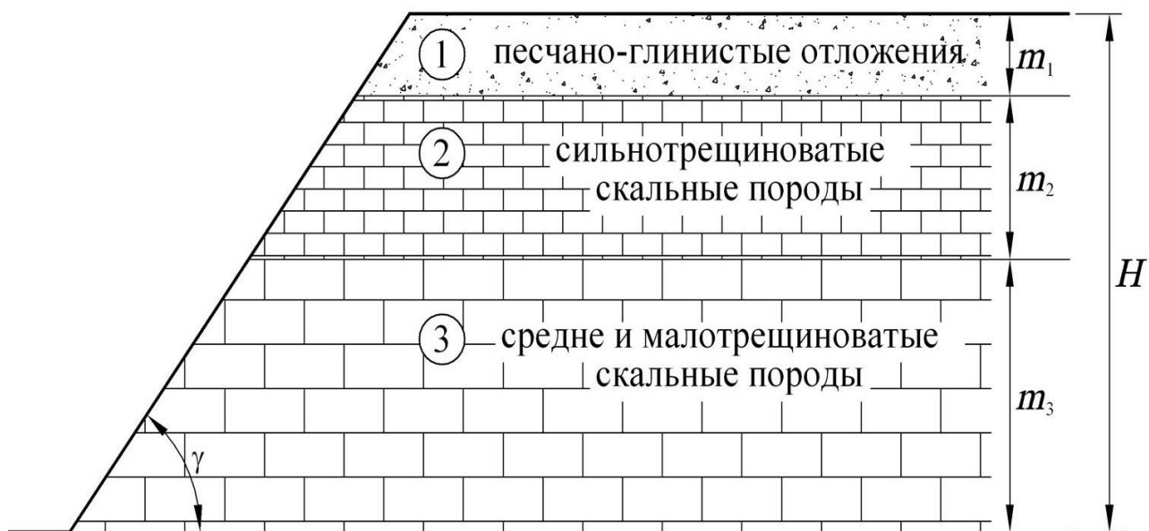
Рис.П1 Схема инженерно-геологического районирования борта карьера
