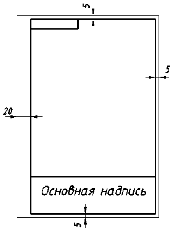
Рис. 3. Расположение основной надписи на формате А4
