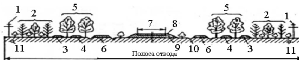
Рис. 1. Полоса отвода и ее элементы:
