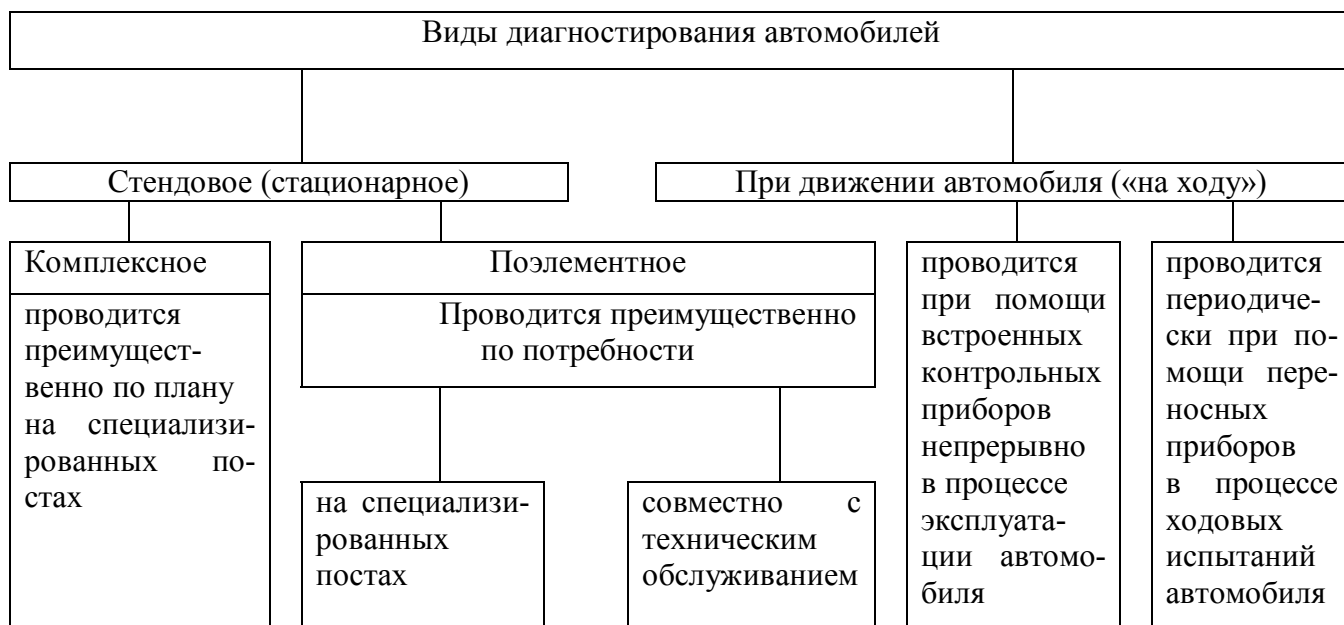
Рис. 2. Виды диагностирования по их технологической принадлежности
