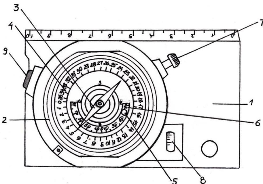
Рис. 1. Устройство горного компаса [8, с. 46]
