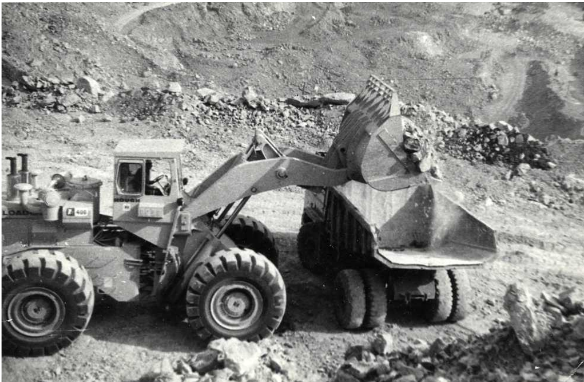
Рис. 2. Относительное положение автосамосвала и погрузчика при разгрузке ковша
