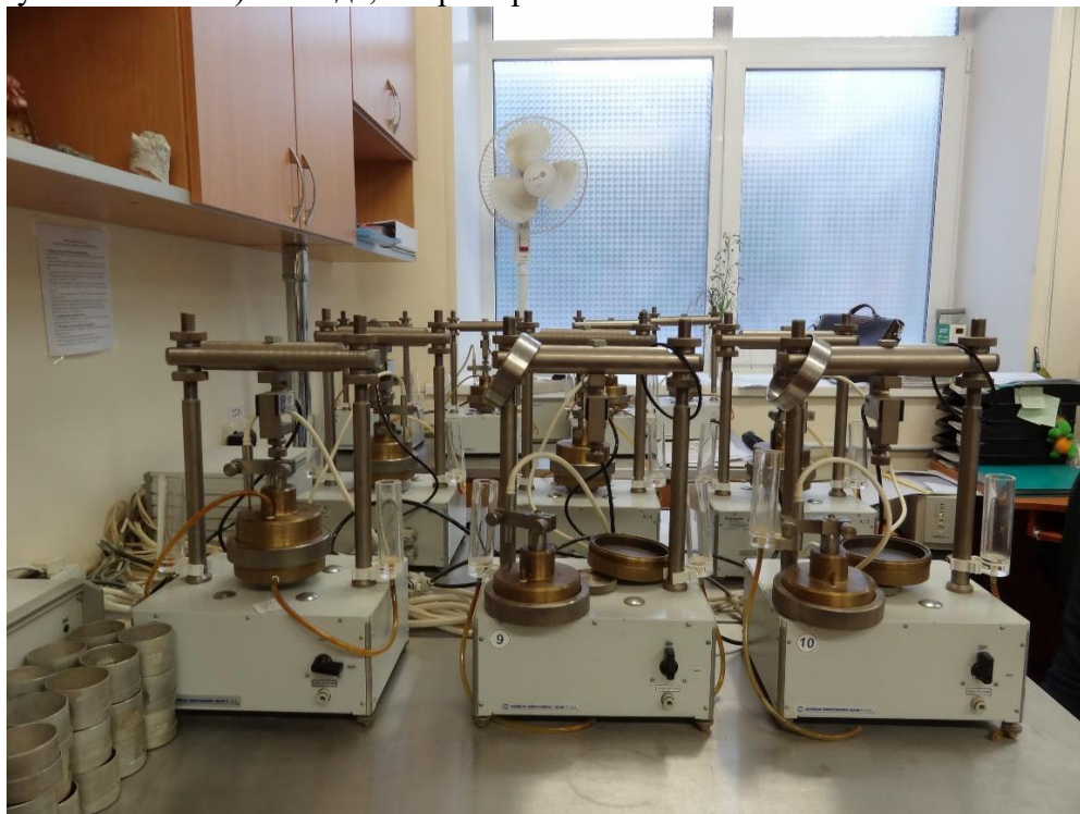
Рис. 1.5 Компрессионные приборы [8, с. 46] 13.6 ПРАВИЛА ОФОРМЛЕНИЯ ТАБЛИЦ
