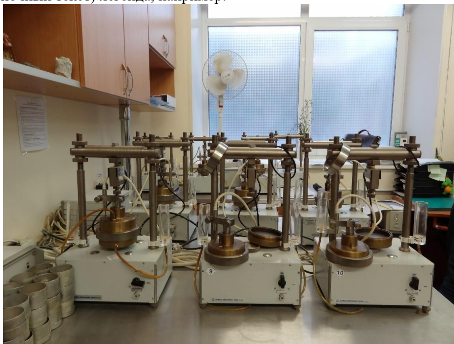
Рис. 1.5 Компрессионные приборы [8, с. 46]
