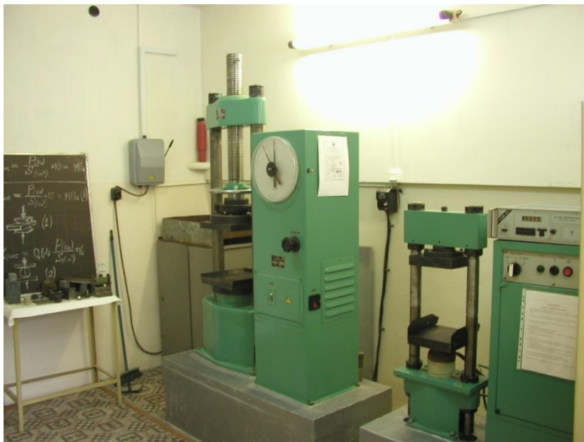
Рис. 1 Прессы в лаборатории физико-механических свойств горных пород
