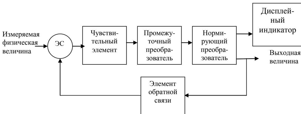
Рис. 6 Структурная схема измерительного преобразователя (датчика) компенсационного типа
