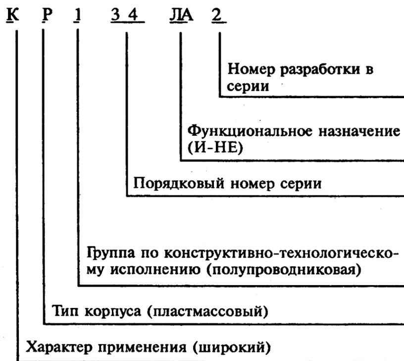
Серии бескорпусных полупроводниковых микросхем начинаются с цифры 7, а бескорпусные аналоги корпусных микросхем обозначаются буквой Б перед указанием серии.
