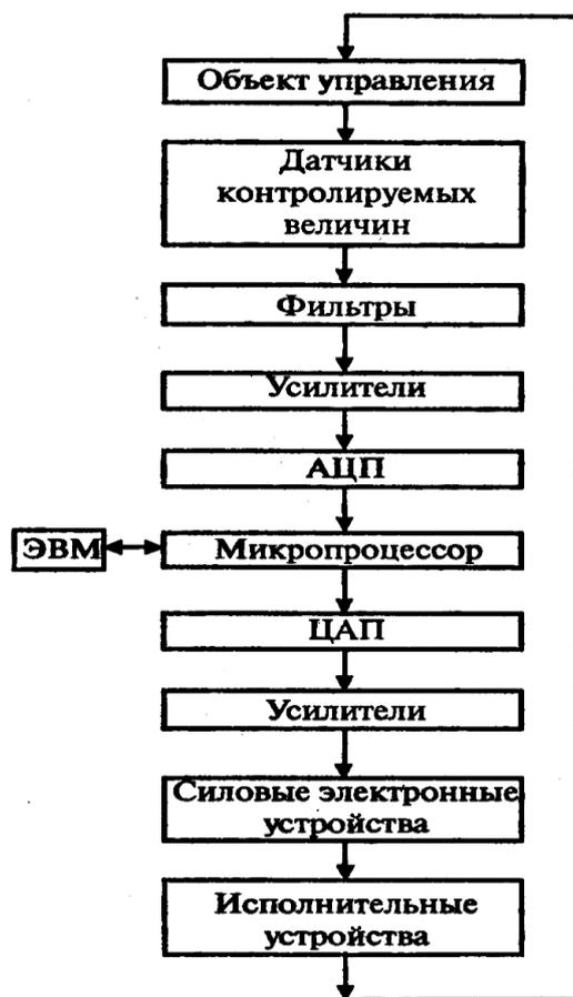
Рис.1.1. Структурная схема системы управления
