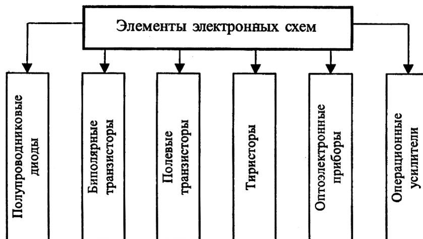
Рис. 2.1. Классификация электронных полупроводниковых приборов
