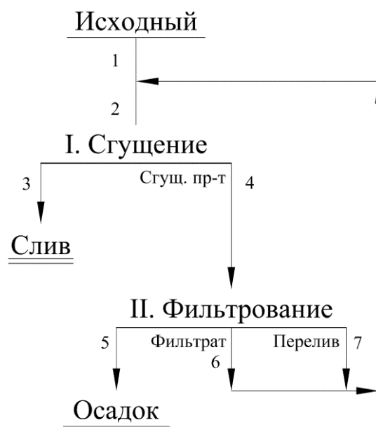
Рисунок 3.1 – Технологическая схема корпуса обезвоживания
