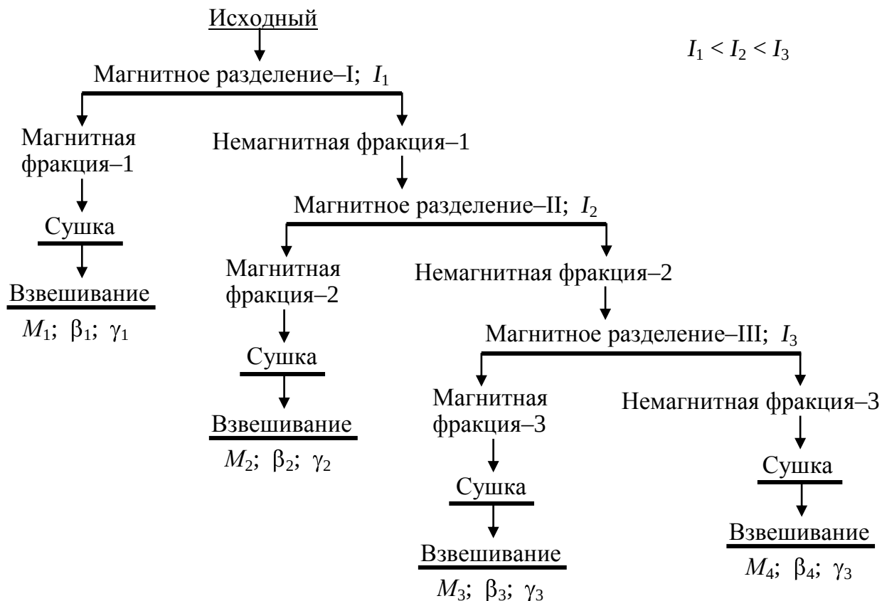
Рисунок 5 – Схема проведения исследования на обогатимость руды магнитным методом
