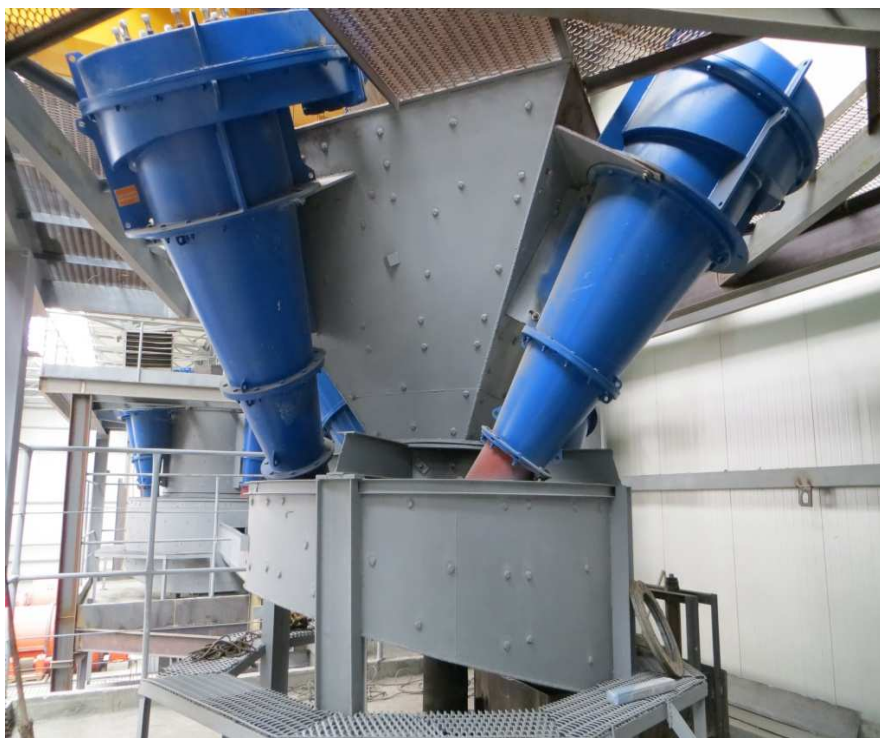
Рисунок 1.5 – Расположение гидроциклонов «звездой»
