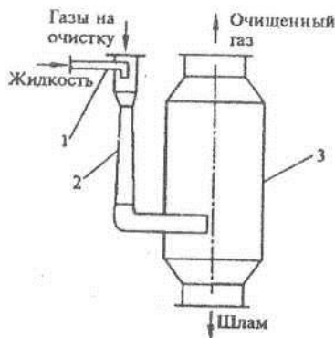
Рис. 5.7. Скруббер Вентури: 1 — орошающая форсунка; 2 — труба Вентури; 3 — каплеуловитель
