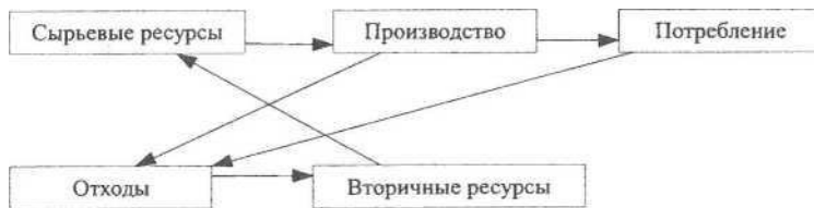
Рис. 3.1. Принцип функционирования малоотходной и безотходной технологии
