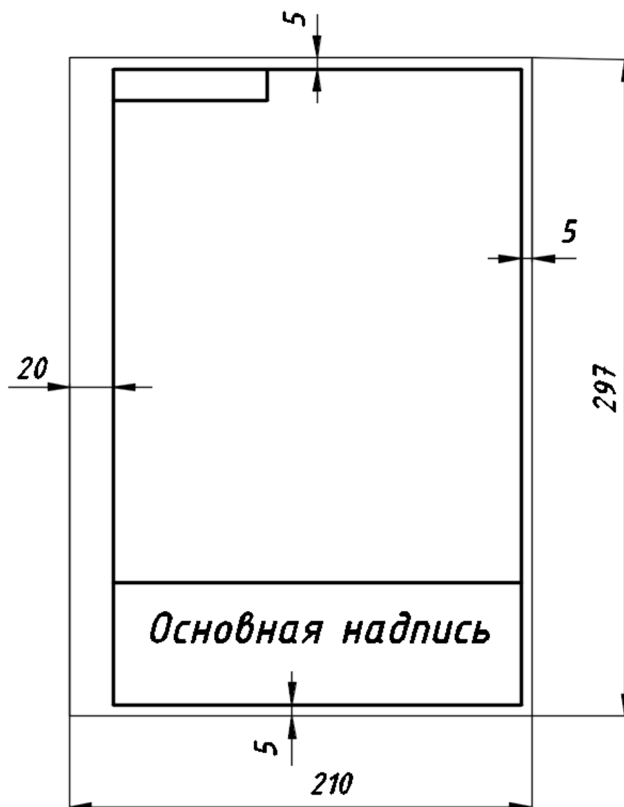
Рис. 3. Расположение основной надписи на формате А4
