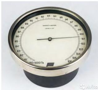
Рис. 3.1 Барометр-анероид «БААМ-1»
