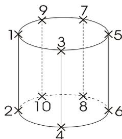
При определении диаметра  $d$  рекомендуется проводить измерения в следующем порядке 1-2, 3-4, 5-6, 7-8, 9-10 :
