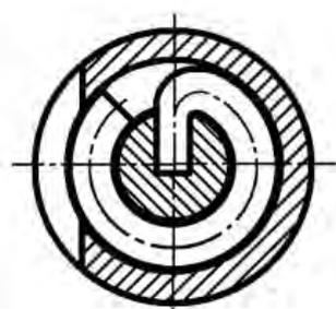
Рис. 4. Соединение клапана со шпинделем при помощи закатки проволоки
