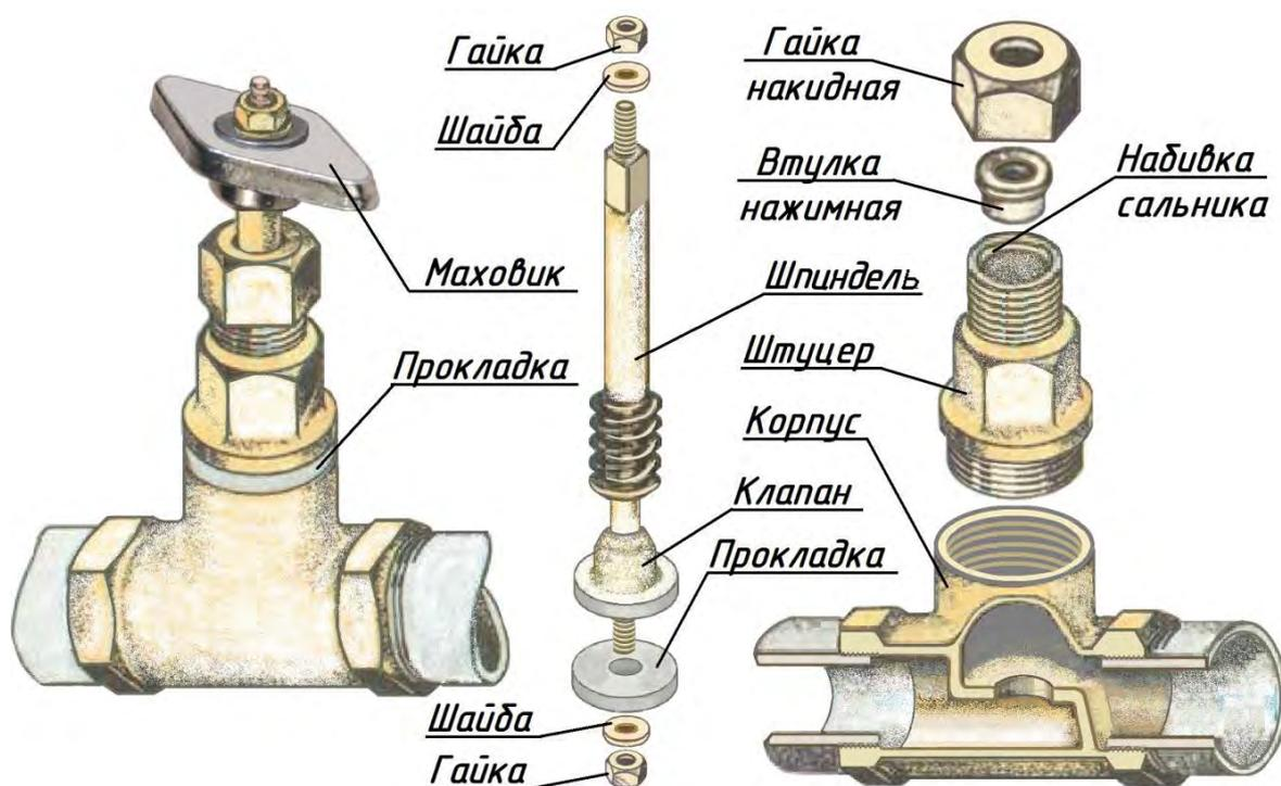
Рис. 1. Конструкция вентиля
