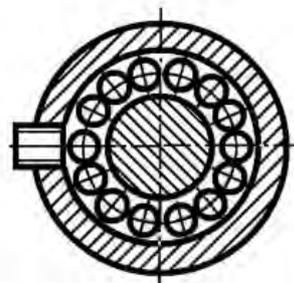
Рис. 5. Соединение клапана со шпинделем при помощи фиксирующих элементов
