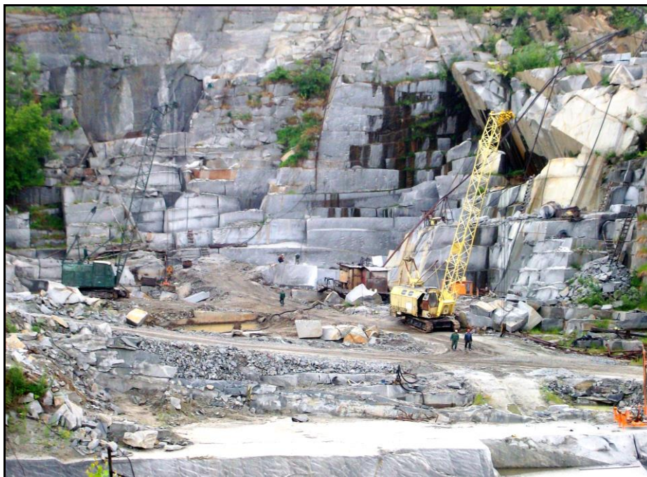
Рис. 22. Сибирский карьер по добыче облицовочных блоков гранитоидов
