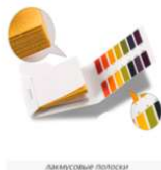
Рис. 1 Шкала изменения цвета лакмусовой бумаги по уровню кислотности водной суспензии
