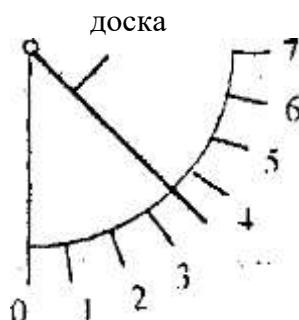
Рис. 1.2. Сектор для определения скорости ветра
