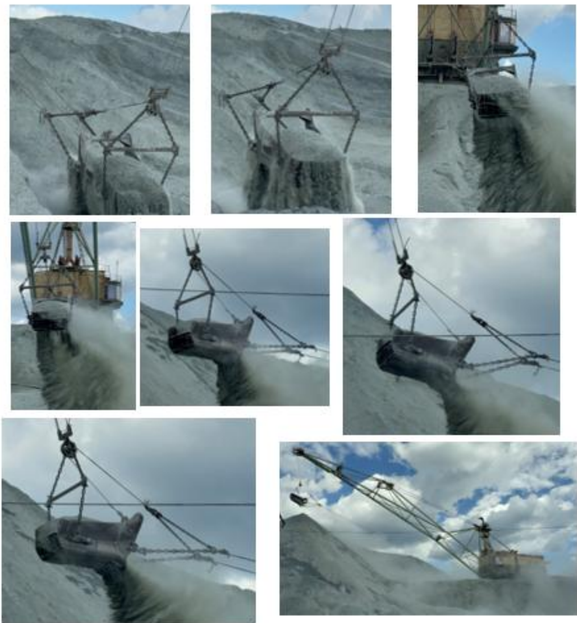
Рисунок 3.4 – Процесс транспортирования горной массы драглайном ЭШ-10/70
