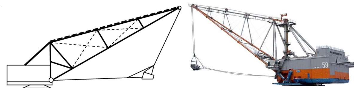
Рисунок 1.3 - Стрела трехгранной жесткой конструкции из четырех панелей
