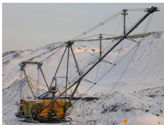
Рисунок 1.2 - Стрела вантовой конструкции с жесткой частью.
