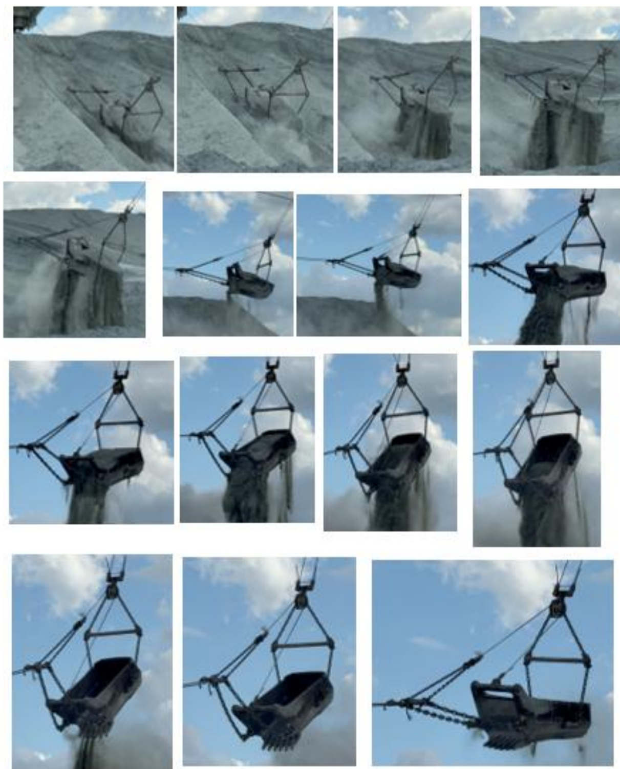
Рисунок 3.3 – Процесс транспортирования горной массы драглайном ЭШ-10/70
