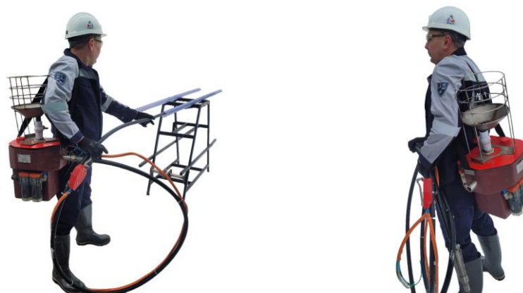
Рис. 4.1. Зарядчик эмульсионный шпуровой РХ-1.
