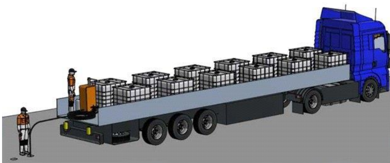
Рис. 4.10. Модуль для зарядания скважин и шпуров РХ-6Н с контейнером ИВС и расположенный на автоплатформе.
