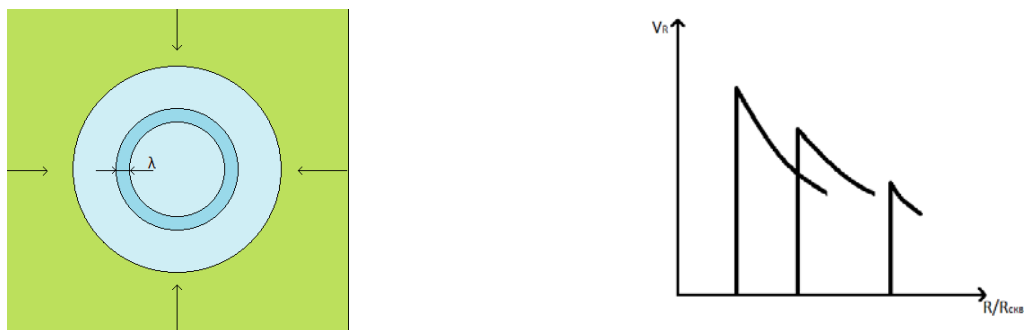
Рисунок 2 – Сходящаяся цилиндрическая ударная волна в скважинном заряде ЭВВ ( R/R_{\text{СКВ}} – относительный радиус)
