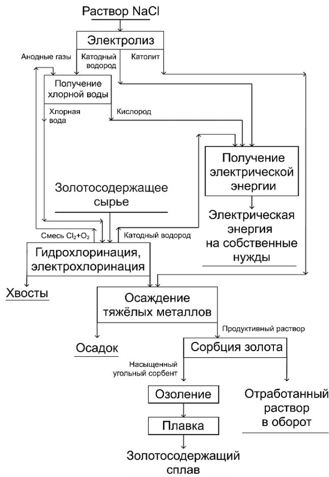
Рисунок 8 – Принципиальная схема комплексного использования получаемых продуктов при переработке золотосодержащего сырья
