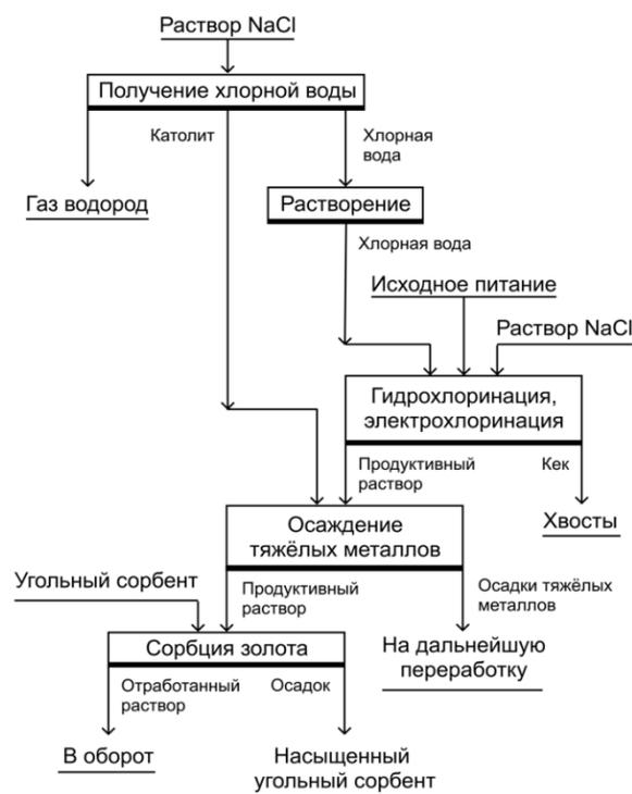
Рисунок 9 – Принципиальная технологическая схема комбинированной совместной гидро- и электрохлоринации хвостов Карагайлинской обогатительной фабрики
