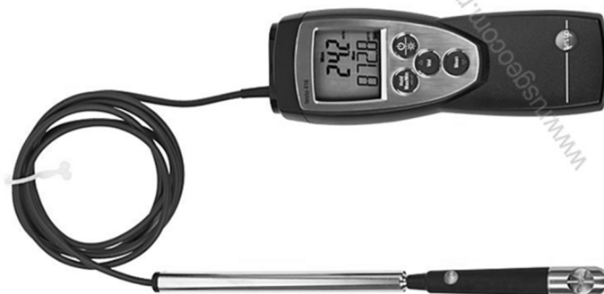
Рис. 3.4. Анемометры крыльчатые: a – МЕГЕОН 11003; б – Testo 416
