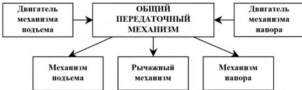
Рисунок 2.3 – Структурная схема электромеханической системы экскаватора
