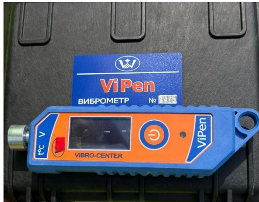
Рис.3.6. Виброметр марки ViPen
