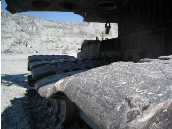
Комментарий: провисание гусеничного полотна выше допустимого
