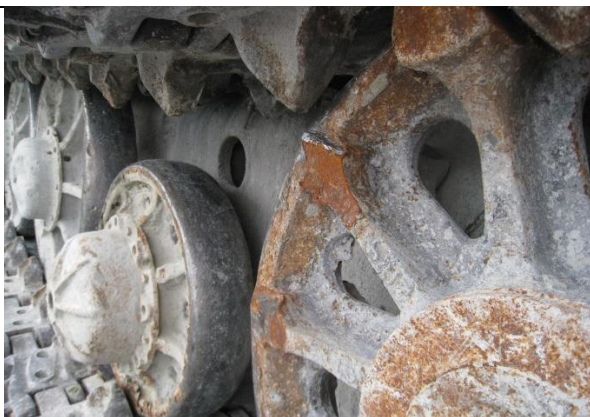
Комментарий: дефекты ведущего колеса, сколы кулачков (4 шт.)
