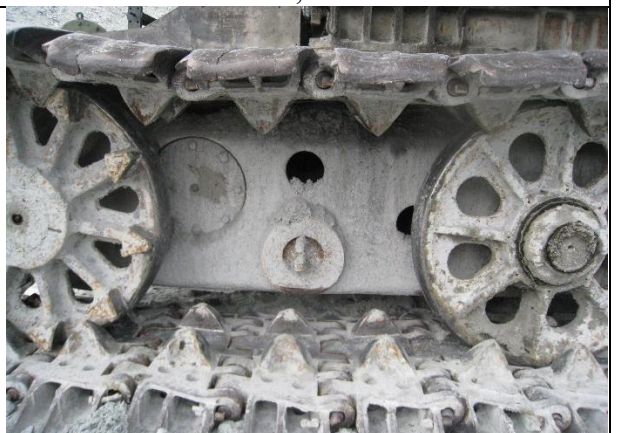
Комментарий: отсутствие опорного катка левой гусеничной тележки
