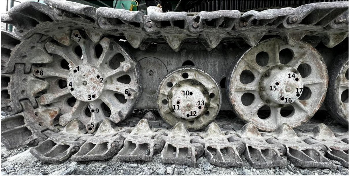
Рис. 3.25 Места установки преобразователей на колесах
