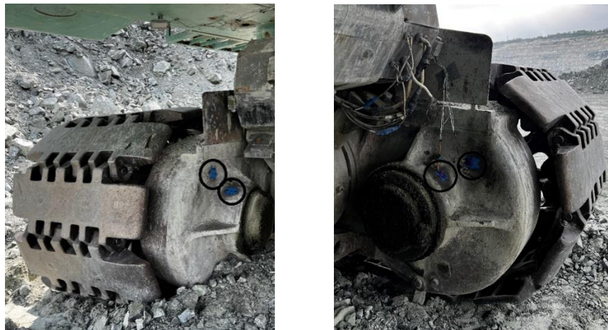
Рис. 3.16. Места установки датчиков-тензорезисторов
