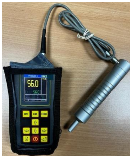
Рис. 3.24. Ультразвуковой твердомер ТКМ-459С
