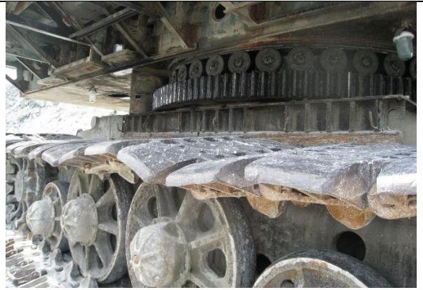
Комментарий: провисание гусеничного полотна выше допустимого
