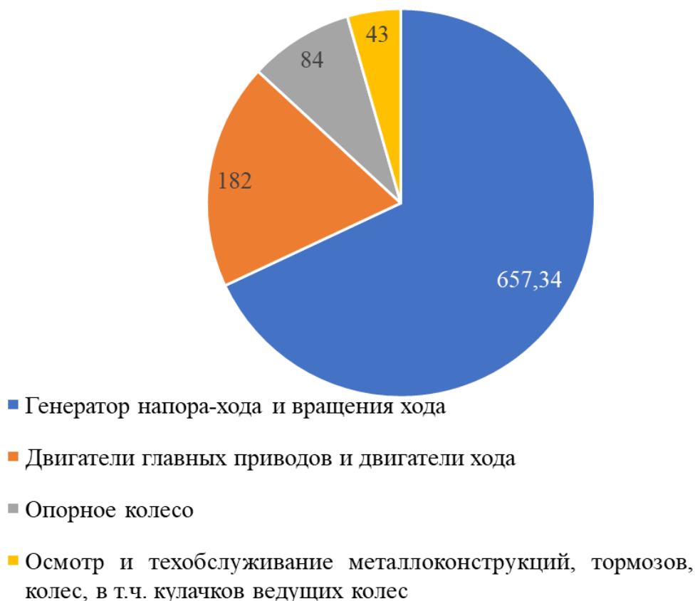
Рис. 3.2. Диаграмма продолжительности технического обслуживания и ремонтов ходового оборудования карьерного экскаватора ЭКГ-10 №333 в период с 01.01.2020 по 01.04.2022, в часах
