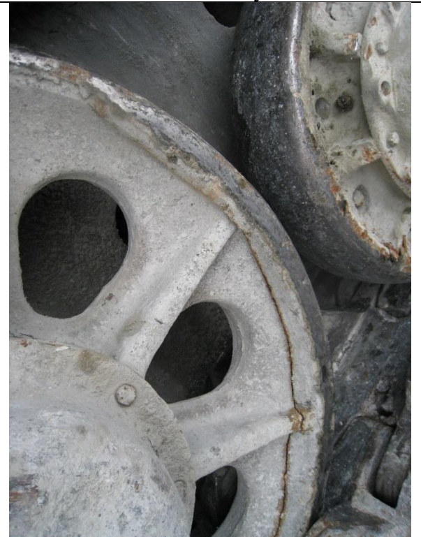
Комментарий: трещина обода опорного катка L=800 мм, наклёп металла
