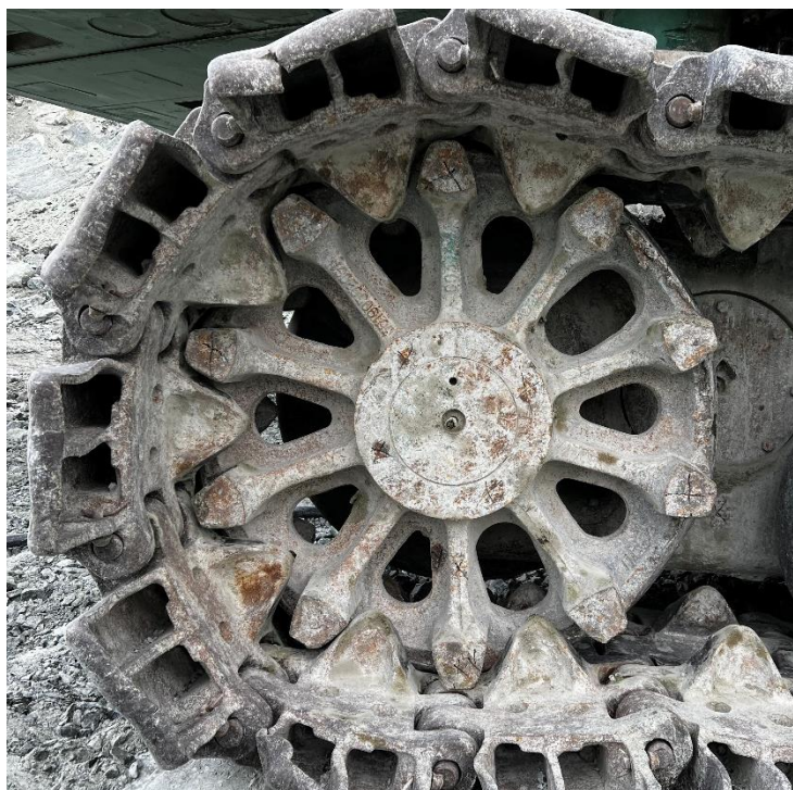
Рис. 4.1. Ведущее колесо гусеничного хода карьерного экскаватор ЭКГ-10
