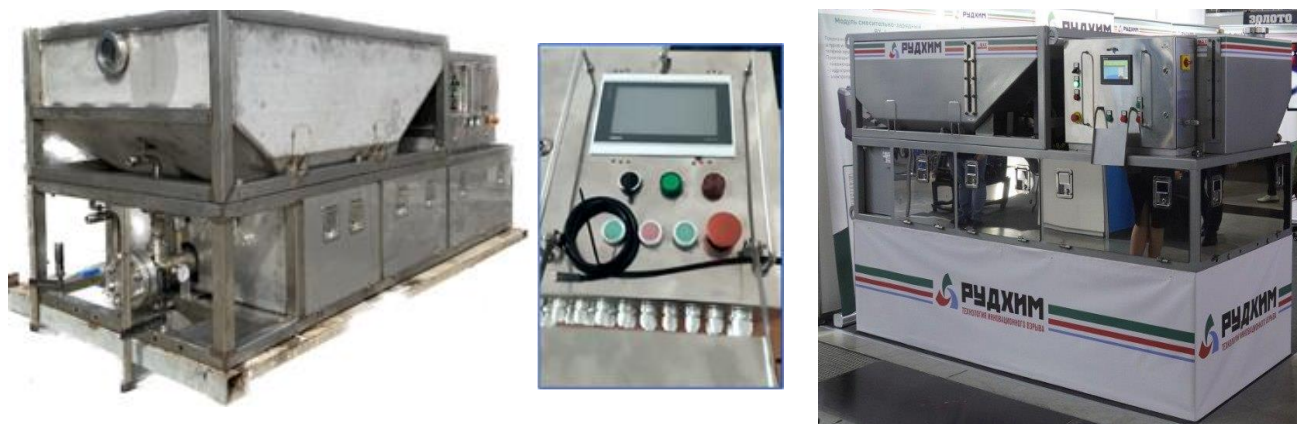
Рис. 4.3. Комплекс для веерного заряжения скважин МСЗ РХ-3
