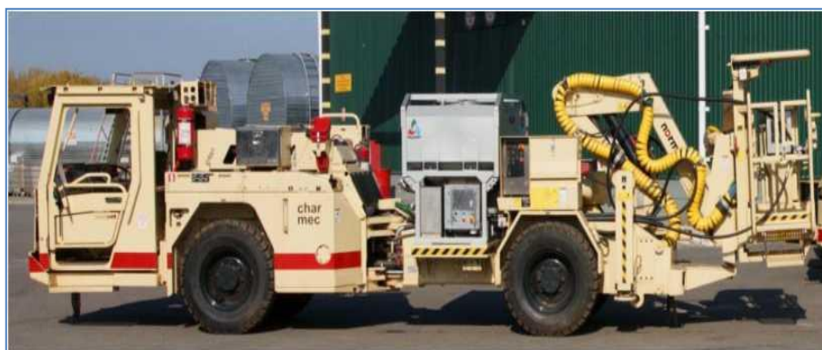
Рис.4.5. Самоходное шасси с установленным модулем смесительно-зарядным для зарядания шпуров и нисходящих скважин МСЗ РХ.
