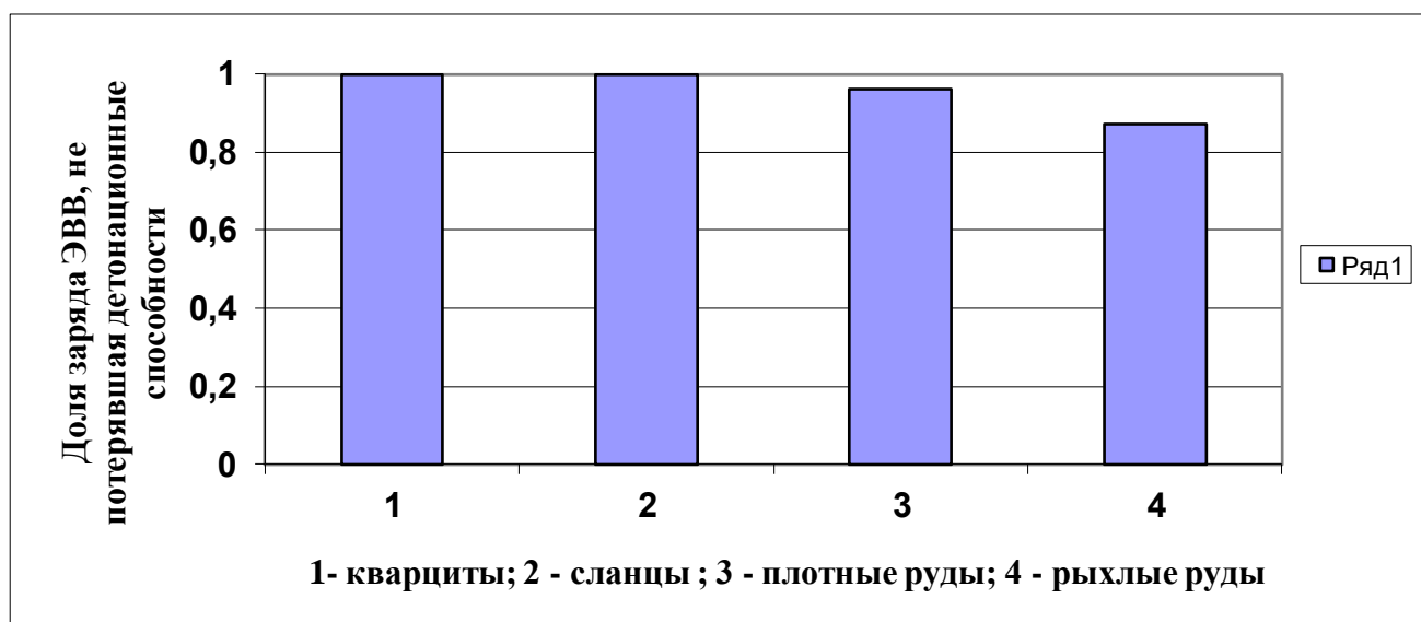
Рис. 2.8. Доля заряда ЭВВ, не потерявшая детонационные способности после динамического воздействия. Плотность ЭВВ – 1,28-1,31 г/см 3 ; относит. радиус равен 30.
