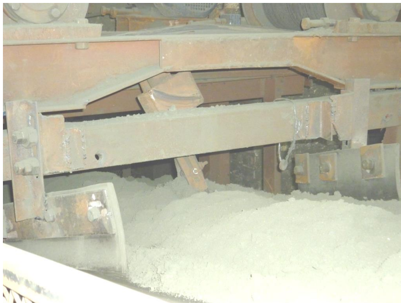
Рисунок 2.2 – Отклонение отсекаателя механического скреперного пробоотборника от исходного положения и первоначальной траектории под действием слоя материала
