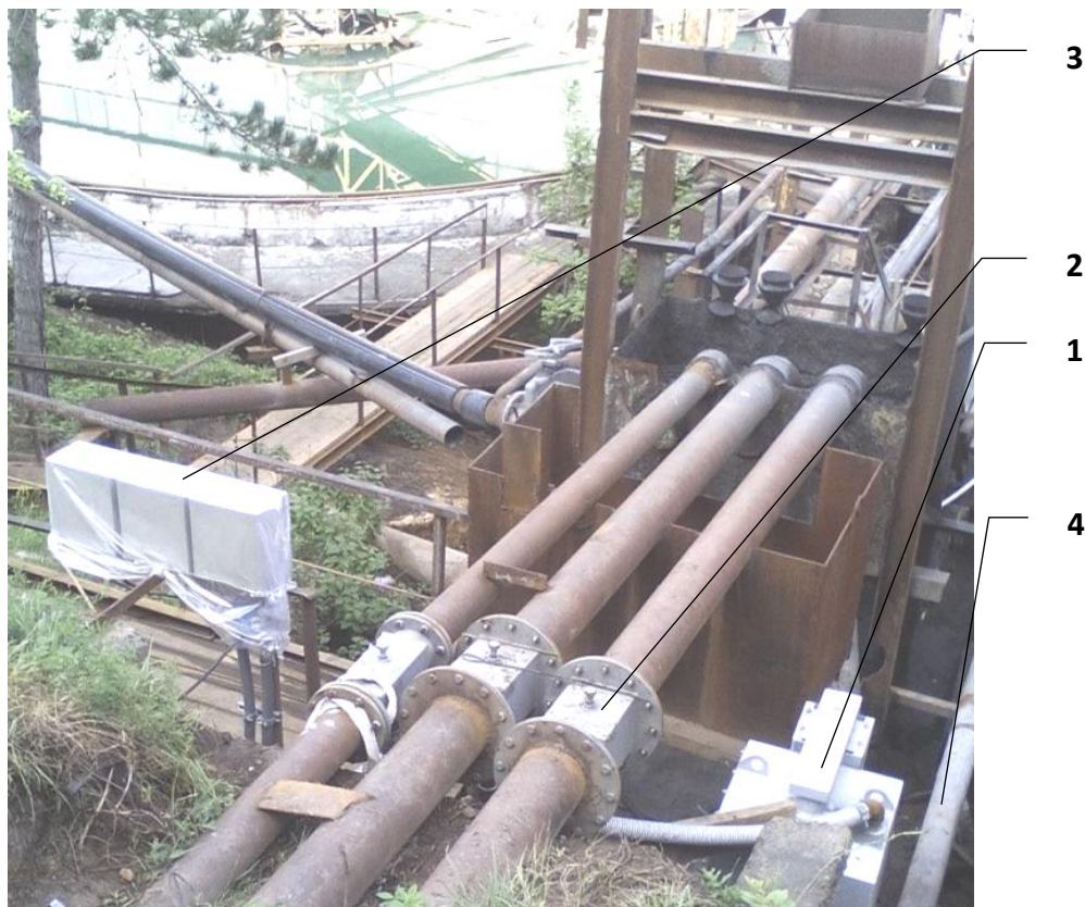
Рисунок 7.13 – Станция опробования СОП-1-219-02П для опробования концентрата флотации с самотечной транспортировкой возвратного потока: 1 – модуль пробосократительный; 2 – пробоотборник; 3 – пульт оператора станции опробования; 4 – трубопровод для самотечной транспортировки возвратного потока
