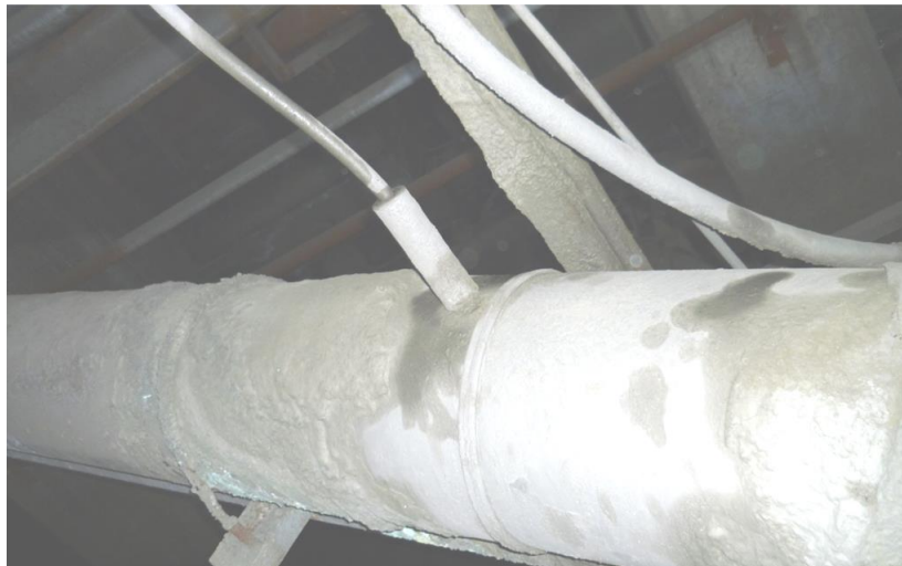
Рисунок 2.3 – Трубный отсекатель вакуумного пробоотборника на трубопроводе круглого сечения
