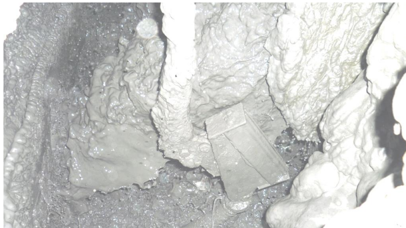
Рисунок 2.6 – Неполное пересечение потока пульпы пробоотсекателем (вертикальная щель меньше высоты потока)
