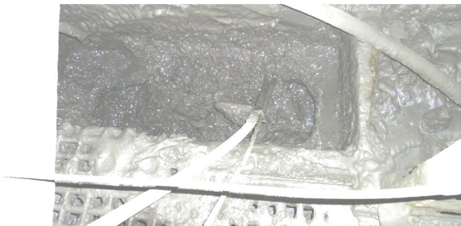
Рисунок 2.4 – Пробоотборная трубка вакуумного пробоотборника в потоке пульпы
