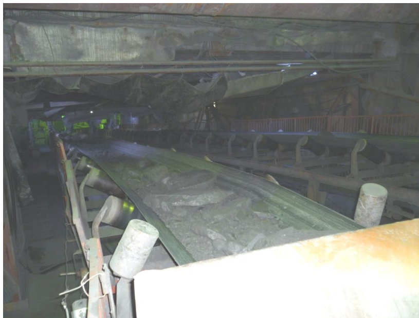
Рисунок 2.7 – Крупные куски исходного сырья на ленте конвейера в зоне отбора первичных точечных проб (в слое материала на ленте присутствуют куски более 300 мм)
