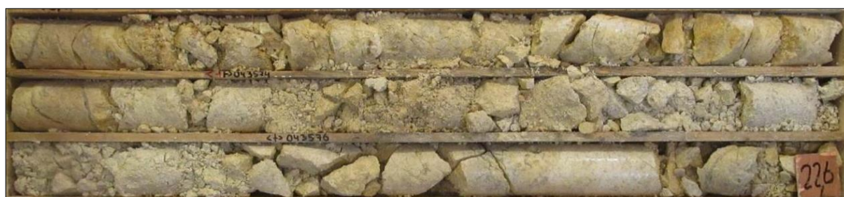
Рисунок 3.59 – Зона ослабления, представленная дресвой и малопрочным щебнем
