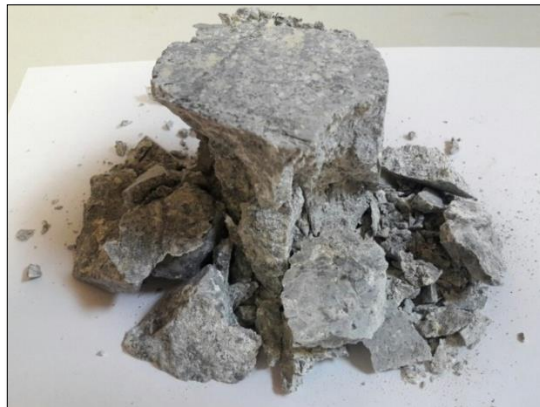
Рисунок 3.30 – Характер разрушения при одноосном сжатии риолитов и их туфов средней прочности
