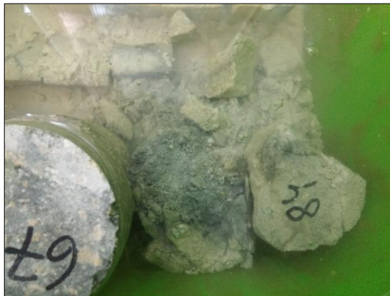
Рисунок 3.29 – Полная потеря прочности кварц-хлорит-гидрослюдистых метасоматитов при водонасыщении
