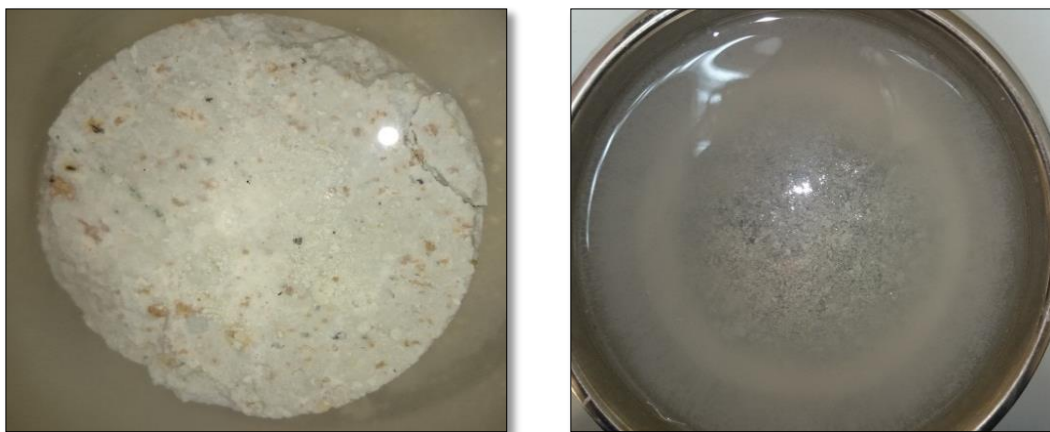
образец до опыта по водонасыщению образец после опыта по водонасыщению Рисунок 3.60 – Водонасыщение образца (проба размокла в течение 6 часов)
