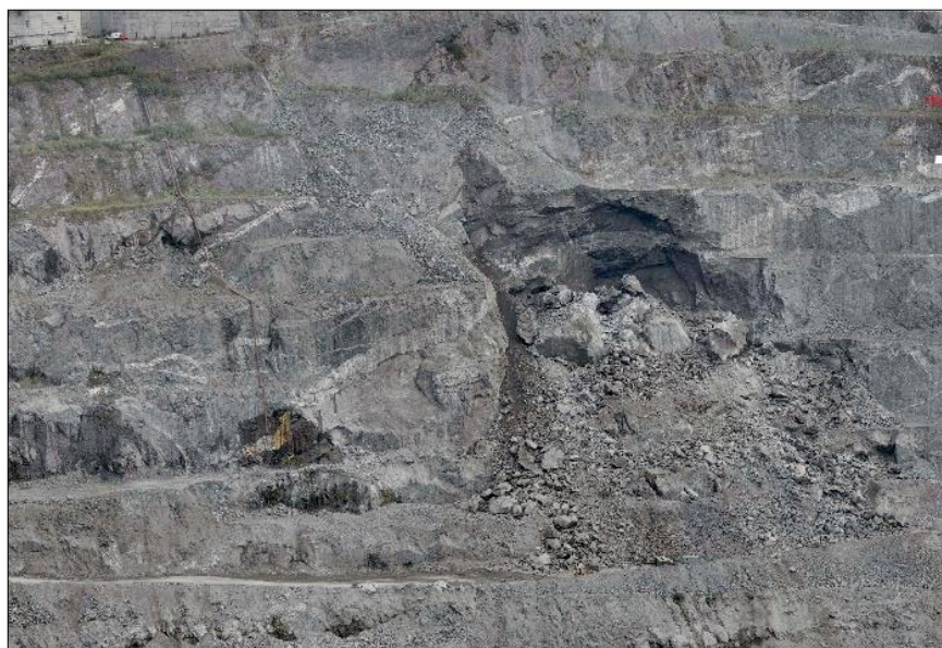
Рисунок 3.38 – Вывал скальных пород в борту карьера
