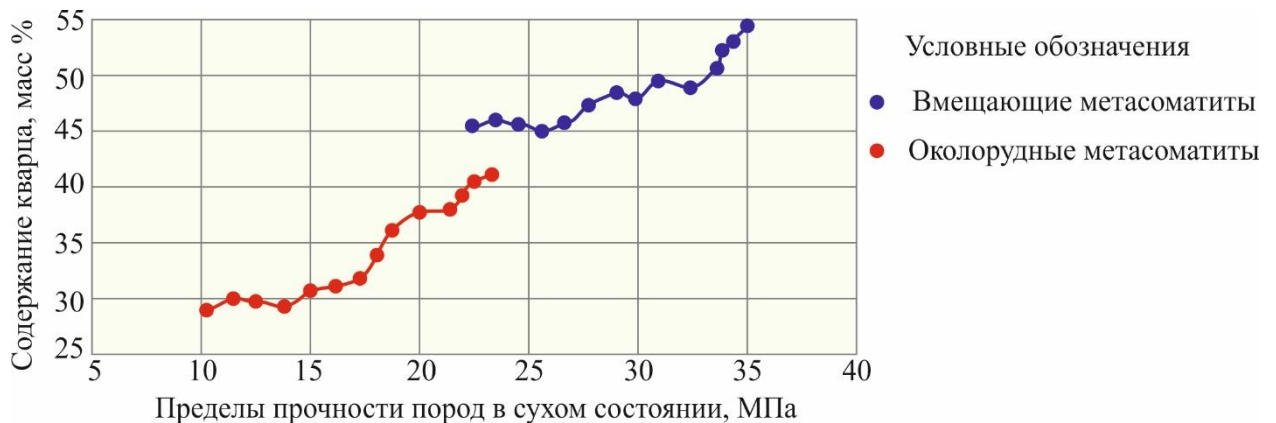
Рисунок 3.22 – Зависимость прочности пород от породообразующих минералов вмещающих и околорудных метасоматитов
