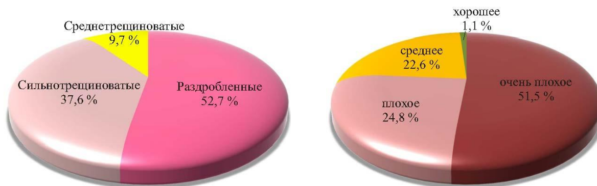
Рисунок 3.61 – Классификация пород по M_t (слева) и RQD (справа) в массиве месторождения Ирбычан
