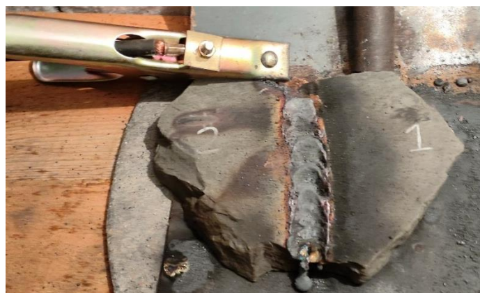
Рис. 3. Сваривание образцов горной породы (халькопирит)
