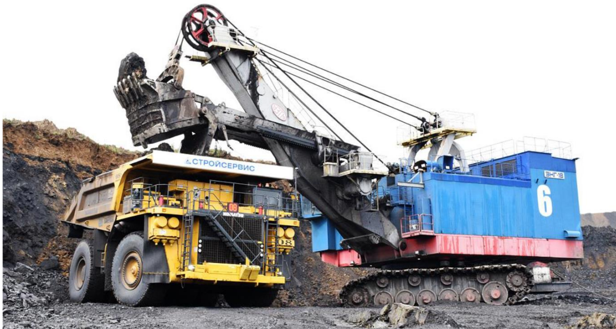
Рис. 2. Экскаватор ЭКГ-18 №6 с ковшом вместимостью 20 м 3 (SAE 2:1) в забое с погрузкой в автосамосвалы 231,2 т Komatsu 830E на разрезе «Березовский» ЗАО «Стройсервис»
