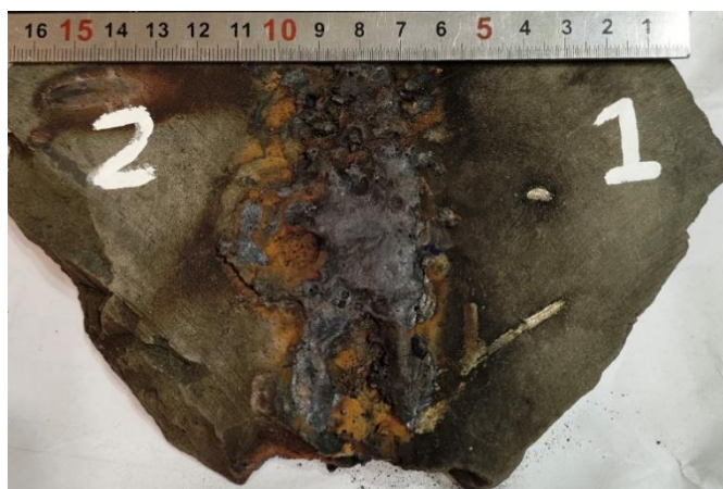
Рис. 4. Сварной шов, образованный на месте стыка образцов
