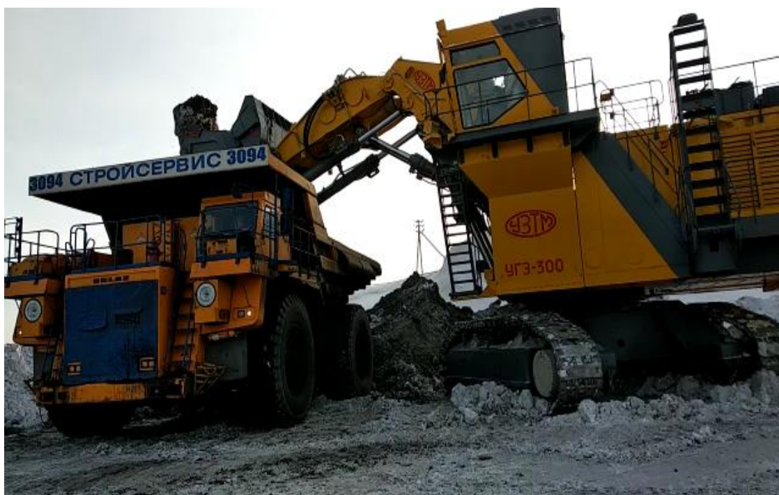
Рис. 3. Карьерный гидравлический экскаватор УГЭ 300 с рабочим оборудованием прямой лопаты с ковшом 16 м 3 на разрезе ООО «Барзасское товарищество» АО «Стройсервис» в 2019 г.
