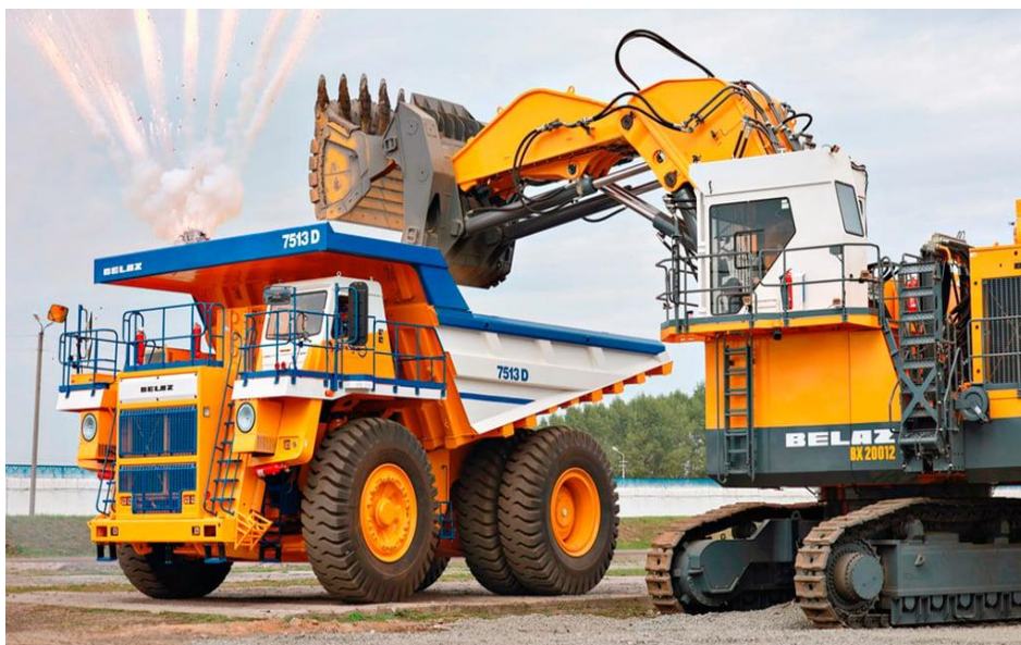
Рис. 4. Карьерный гидравлический экскаватор Белаз ВХ-20012 с ковшем 12 м 3 (насыпная плотность в ковше 1,78т/м 3 ), мощность двигателя 1167 л.с., вырывное усилие 770кН
