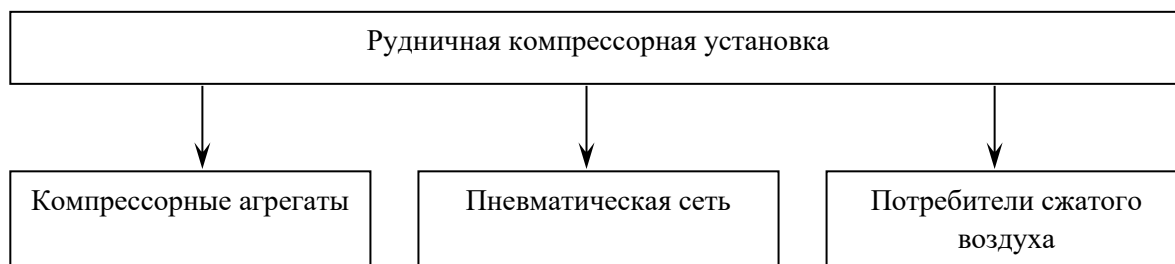
Рис. 1. Рудничная компрессорная установка, как техническая система
