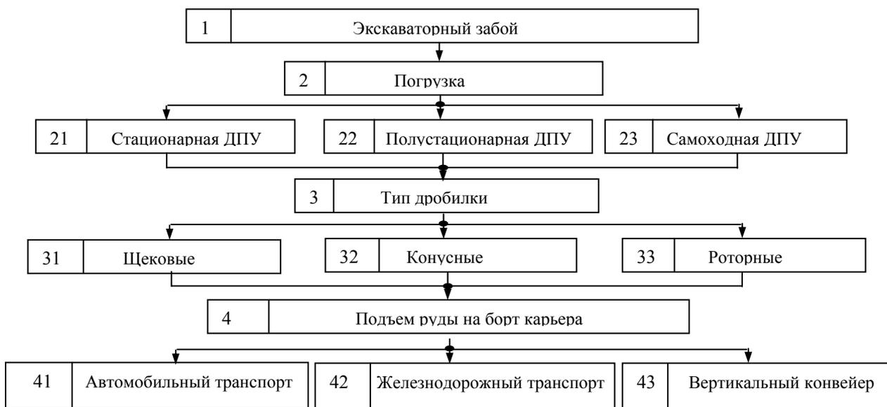
Рис. 1. Схема циклической и циклично-поточной технологий
