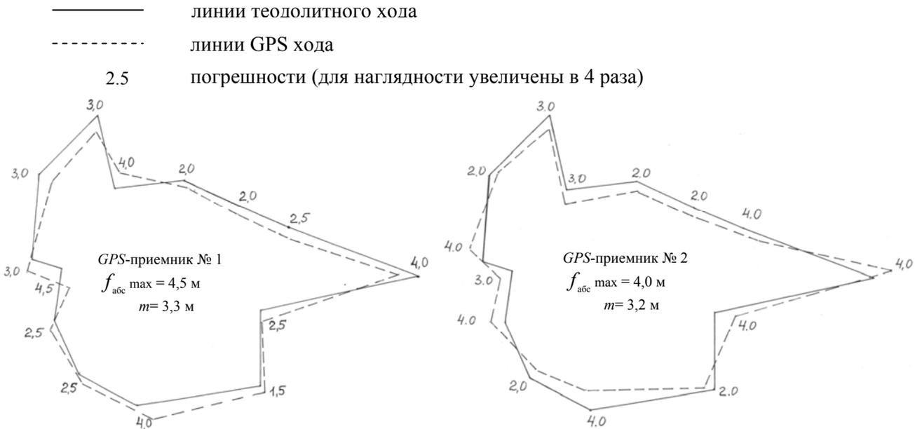
Рис. 2. Схема определения погрешности GPS-измерений на участке «Магнитный»
