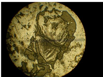
Рис. 1. Каркасная структура лимонита
