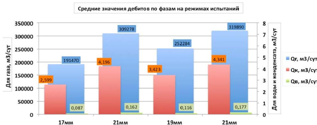
Рис. 2. Фазовые дебиты на режимах испытаний
