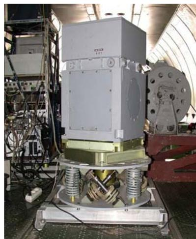
Рис. 2. Аэрогравиметр ГИ-1
