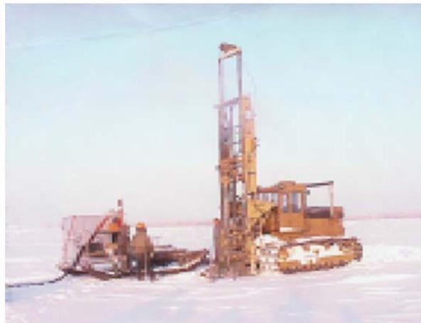
Рис. 2. Шнековая установка для бурения взрывных скважин
