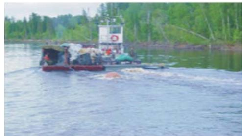
Рис. 2. Двухсудовая технология при работах на р. Вах в Западной Сибири. Размотка донной косы с борта малотоннажного судна
