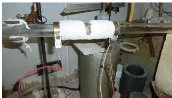
Рисунок 2 – Горизонтальная печь с окошком для хлорирования карбидов
