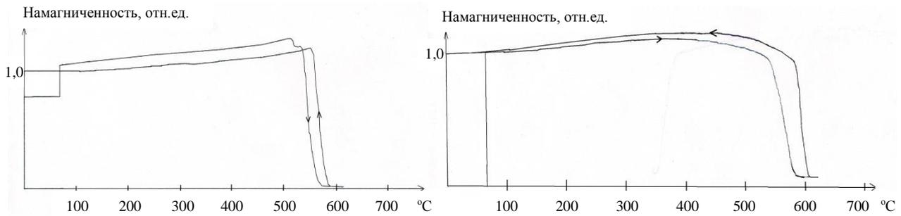
Рисунок 2 – График зависимости намагниченности насыщения образца Г-2 (слева) и Г-3 (справа) от температуры
