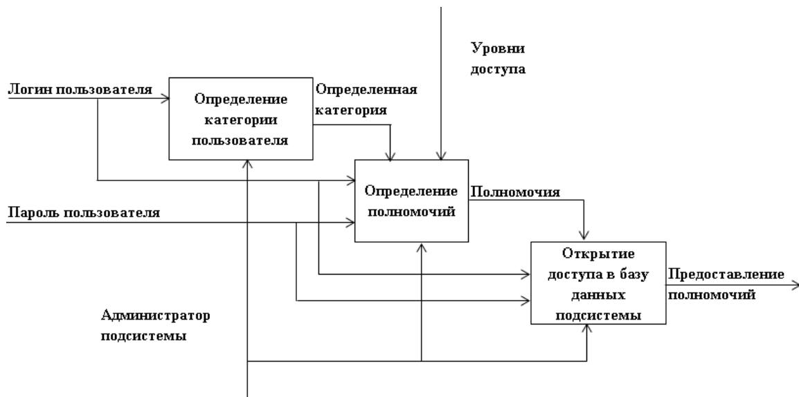
Рисунок 3 – Декомпозиция работы «Определение уровня доступа в подсистему»
