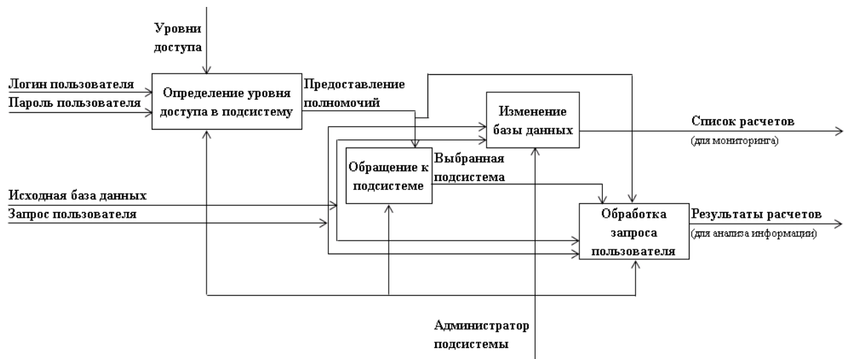
Рисунок 2 – Декомпозиция работы «Обслуживание пользователя подсистемы»
