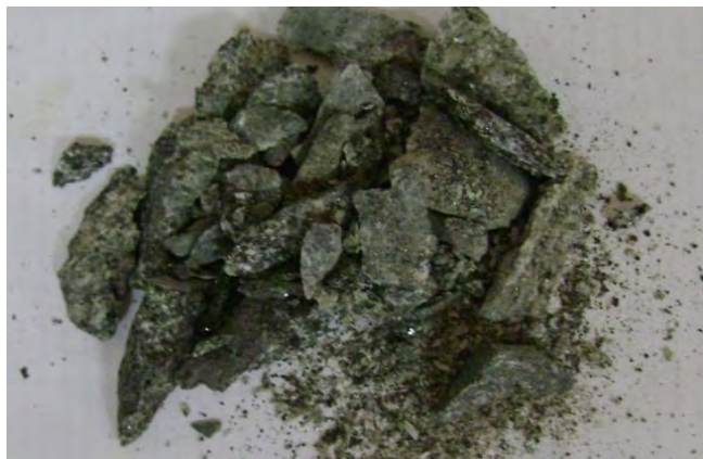
Рисунок– Вид образца пробы (интервал 321,0–323,0 м) после разрушения
