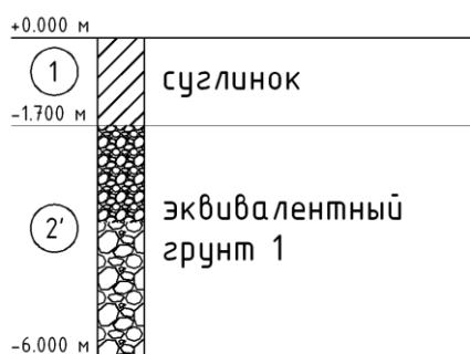
Рисунок 2 – Объединение двух смежных слоёв грунта при расчёте
