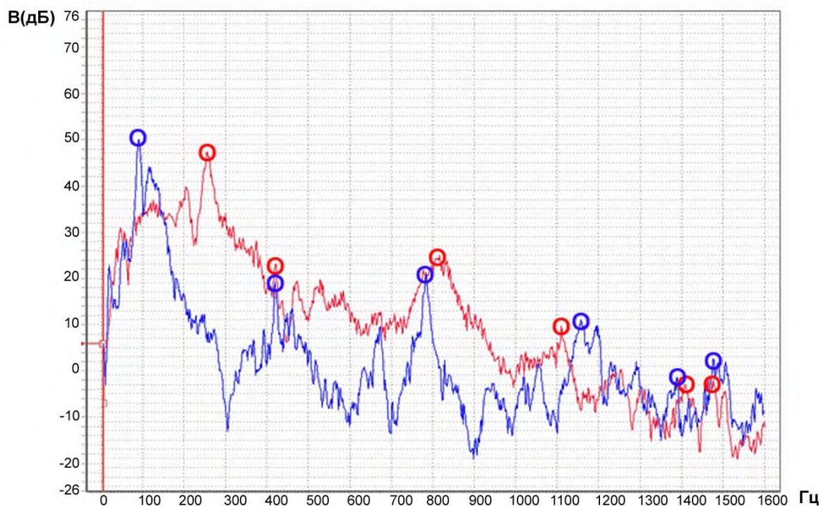
Рисунок 1 – Частотная характеристика источника броуновского шума 0–1600 Гц: верхний график – без использования мраморной плиты, нижний – с использованием мраморной плиты 30 ×195×270 мм
