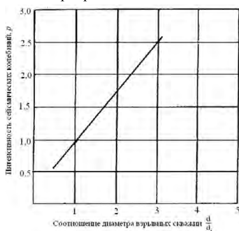
Рис. 1. Изменение интенсивности сейсмических колебаний в зависимости от диаметра скважин
