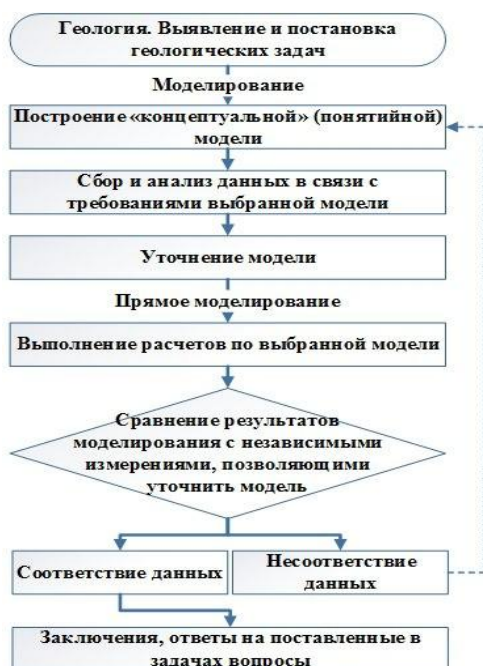
Рисунок 1 - Блок-схема (синтез представлений Р. Мак-Кеммона и др., 1973; Дж. Харбуха и Г. Бонэм-Картера, 1974; P. Bruszek, 2015; J. Derks, Th. Fuchs и др., 2009), показывающая последовательные этапы моделирования
