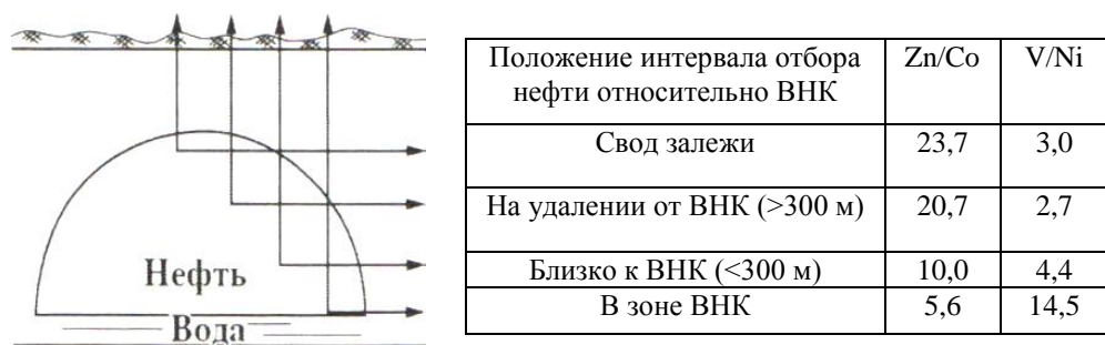
Рисунок – Влияние ВНК на микроэлементный состав нефтей Западно-Тэбукского месторождения [1]
