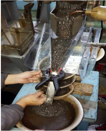
Рисунок 1 – Общий вид флотомашины с сужающимся желобом
