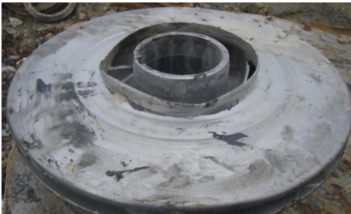
Рисунок 2 – Местный износ рабочего колеса насоса ЦНСК-300-360
