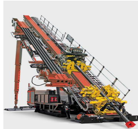
Рисунок.3 - Буровая МНГБУ PV 250 гусеничном ходу.
