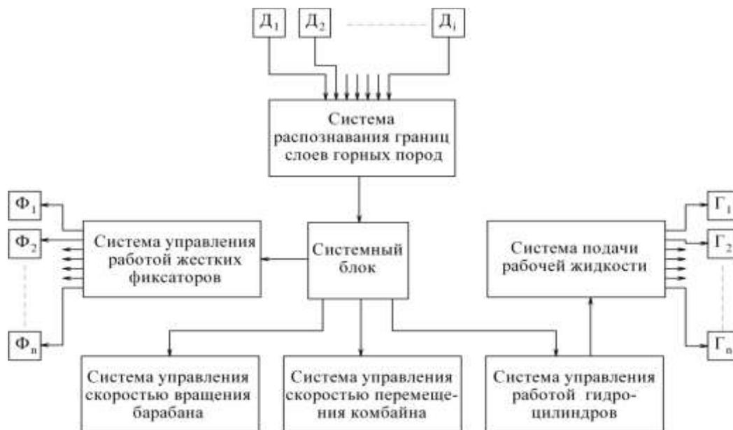
**Рис. 3. Блок-схема управления фрезерным рабочим органом**
