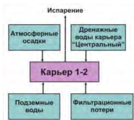
**Рис. 1. Принципиальная схема водного баланса карьера 1-2 при заполнении его дренажными водами карьера «Центральный» ОАО "Ураласбест"**
