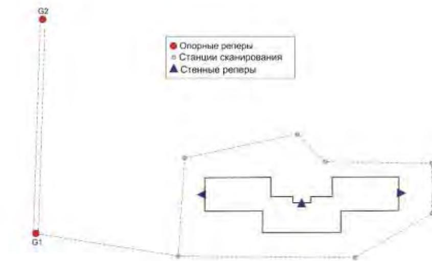
**Рис. 1. Схема сооружения и наблюдательной станции**
