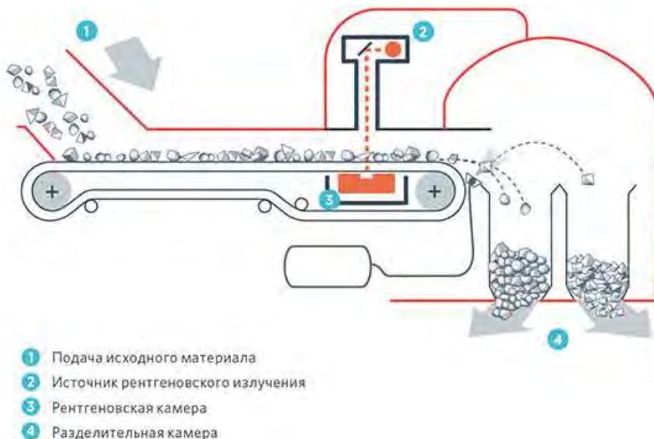
**Рис. 1. Принцип работы сортировочного оборудования**
