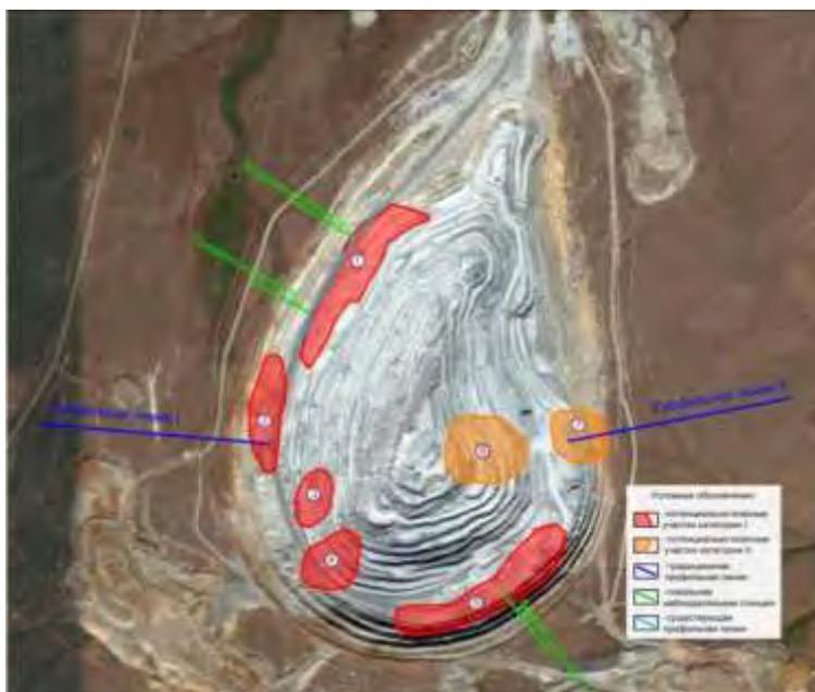
Рис. 5. Схема наблюдательной станции Киембаевского карьера
