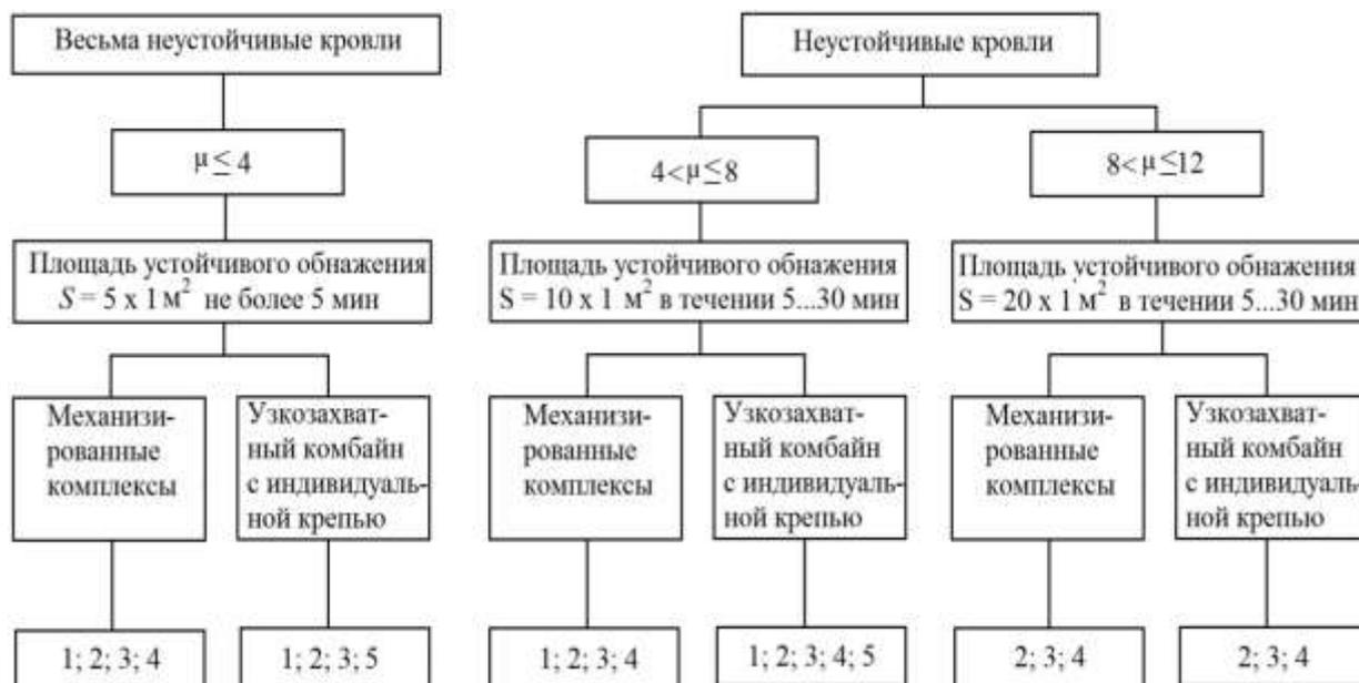
**Рекомендуемые мероприятия по повышению устойчивости кровли:** 1 – защитная пачка угля; 2 – опережающее химическое анкерование; 3 – нагнетание вяжущих составов; 4 – частичная затяжка кровли; 5 – сплошная затяжка кровли
