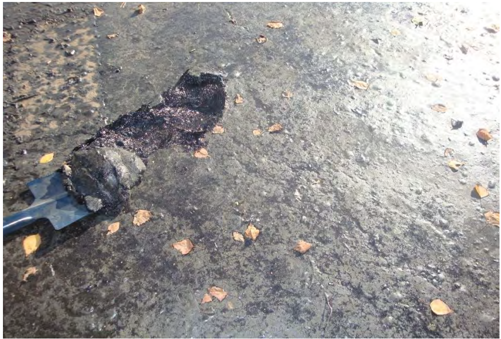
Рис. 2 Смола в смолоотстойнике Динасового завода (в летний период)
