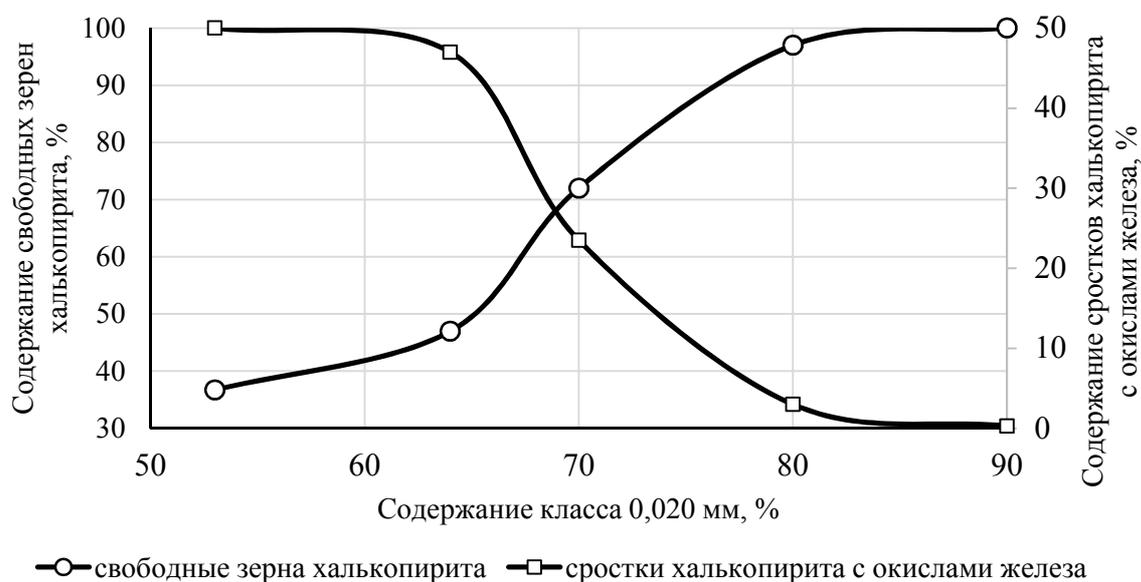
**Рисунок 3 – График зависимости содержания свободных зерен халькопирита и его сростков с окислами железа от содержания класса 0,020 мм в измельченном продукте**
