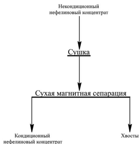
**Рисунок 1 – Технологическая схема повышения качества нефелинового концентрата**
