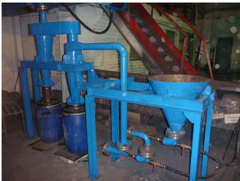
**Рисунок 2 – Фото опытно-промышленной струйной мельницы для измельчения пека на ОАО «Огнеупоры» в г. Богданович**
