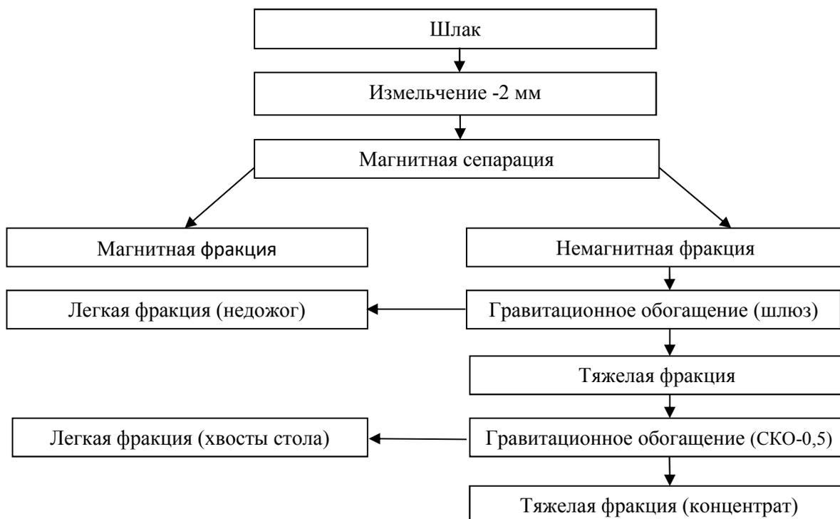
**Рисунок 1 – Схема магнитного и гравитационного обогащения шлаков**
