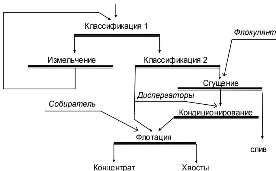
**Рисунок 2 – Принципиальная схема измельчения и флотации АШР совмещенной флотацией песков и сгущенного шламового продукта с кондиционированием шламового продукта с реагентами–диспергаторами**
