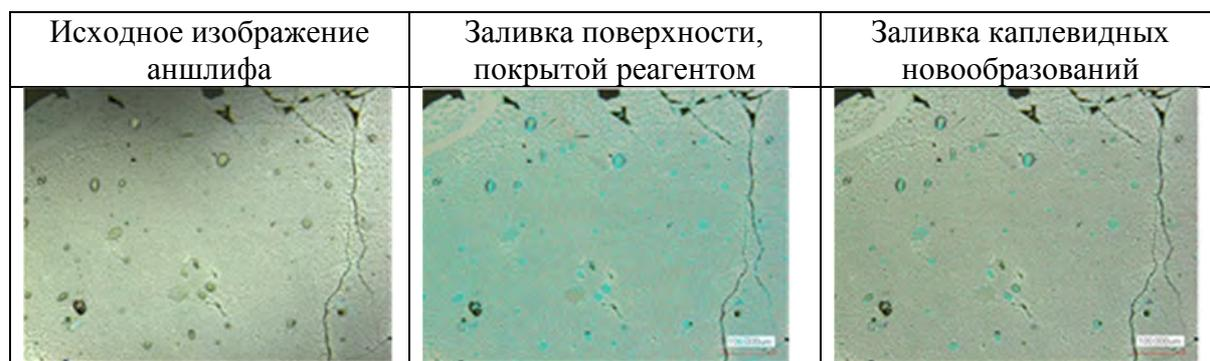
**Рисунок 1 – Определение площади поверхности участка аншлифа арсенопирита, покрытой реагентом ДЭДТКк**
