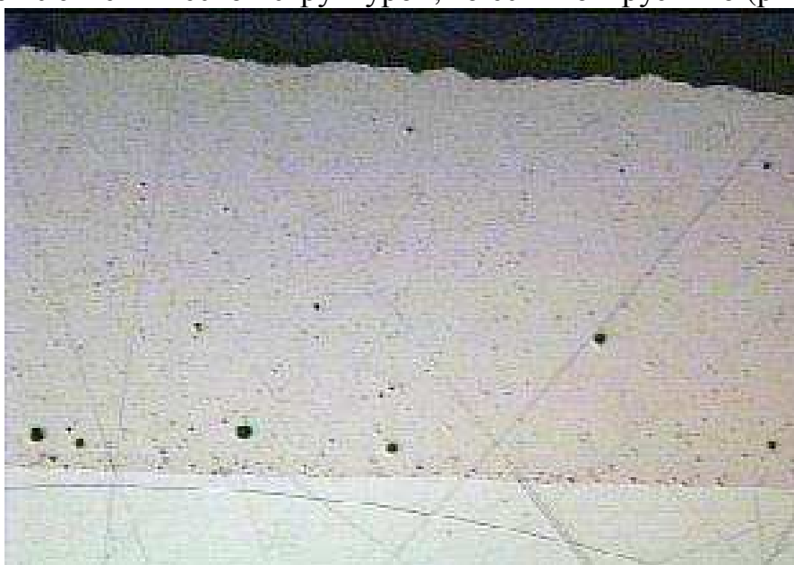
Рис. 3 Типовая структура покрытия после напыления с оплавлением.
