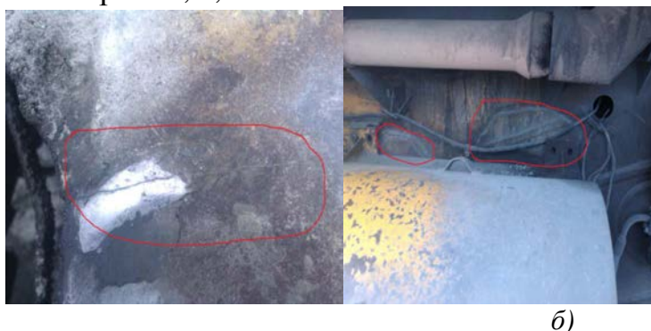
Рис. 1. Примеры дефектов рамы.
