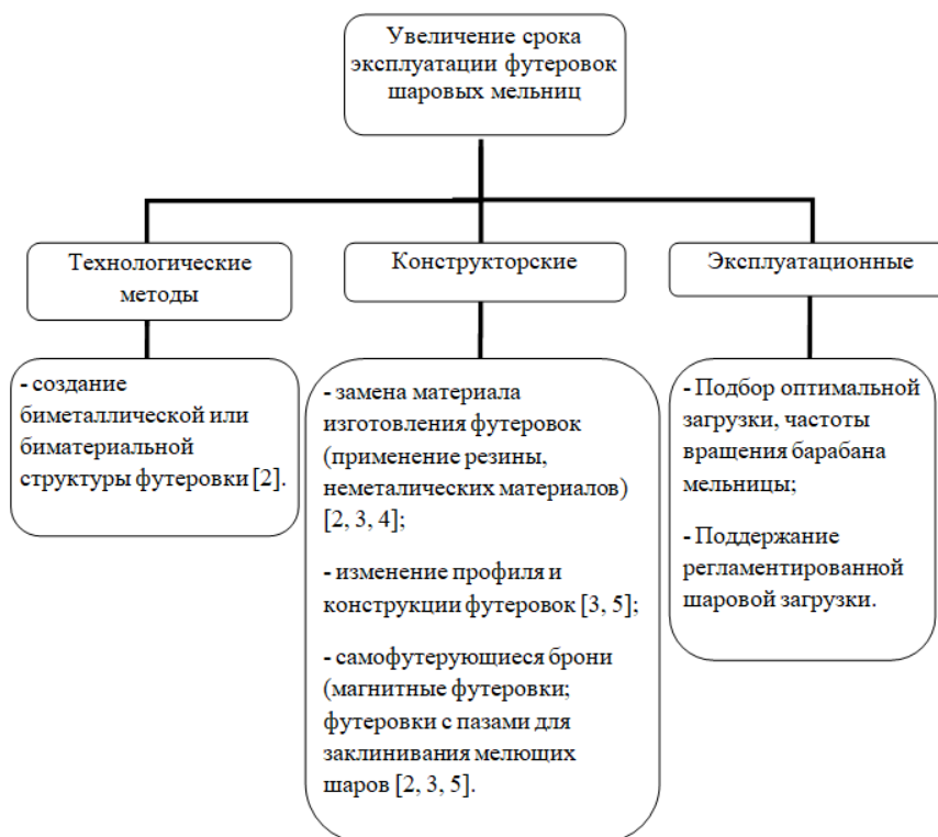
Рис. 2. Алгоритм мероприятий по повышению срока эксплуатации футеровки шаровой мельницы
