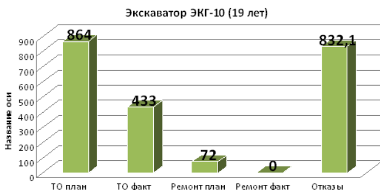
Рис.1 – Выполнение технического обслуживания и ремонта экскаватора
