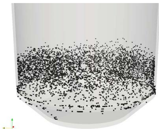
Рис. 2. Положение мелких частиц в установившемся режиме
