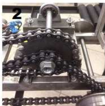
Рисунок 1 – Исследовательский стенд: 1 – общий вид; 2 - понижающая передача; 3 – диммер; 4 - электронный динамометр серии АЦД
