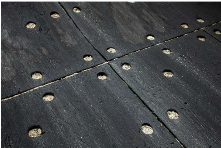
Рис. 2. Элементы резиновой футеровки
