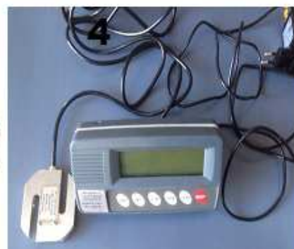
Рисунок 1 – Исследовательский стенд: 1 – общий вид; 2 - понижающая передача; 3 – диммер; 4 - электронный динамометр серии АЦД
