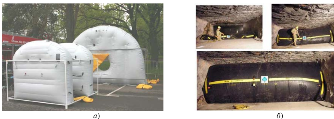
Рис. 1. Воздушная шахтная вентиляционная перемычка
