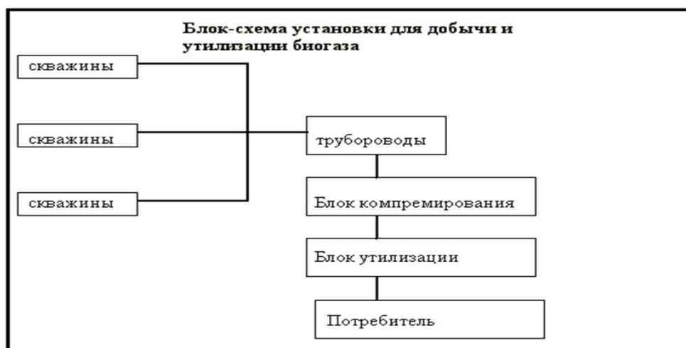
Рисунок 1 – Технологическая схема экстракции и утилизации СГ
