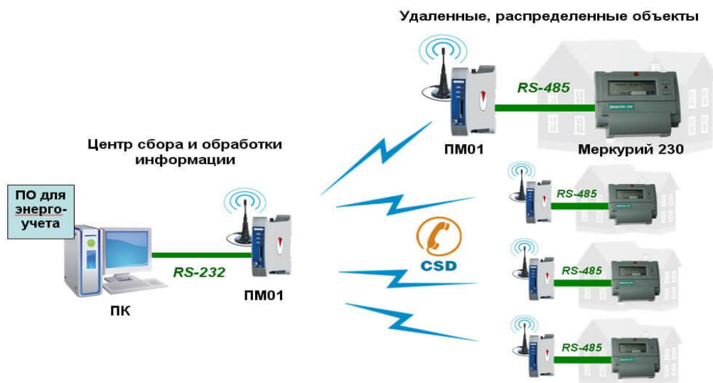
Рисунок 1 – Упрощенная структурная схема АСКУЭ
