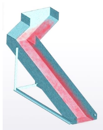
Рисунок 4 – Модель нагружения короба
