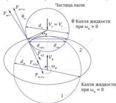
Рисунок 1 – Модель вихревой кинематической коагуляции частицы пыли каплей жидкости
