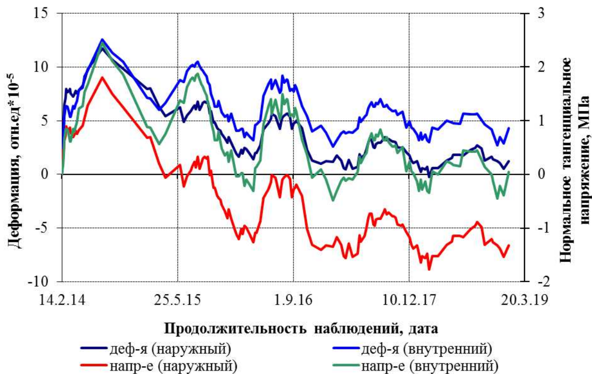
Рис. 4. – Типичный график развития относительных деформаций и нормальных напряжений во временной обделке в зоне свайного ограждения
