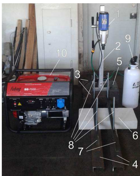
Рис. 1. Мобильная установка для выбуривания керна
