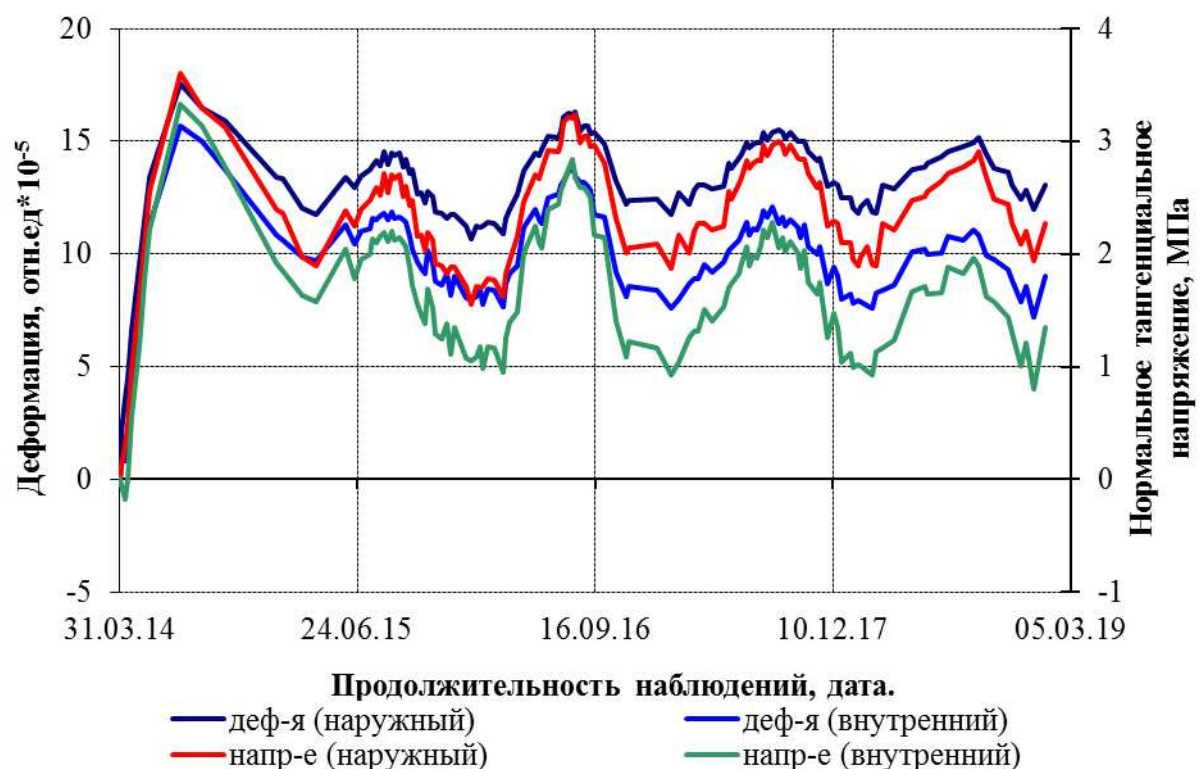
Рис. 5. – Типичный график развития относительных деформаций и нормальных тангенциальных напряжений во временной обделке ниже зоны свайного ограждения
