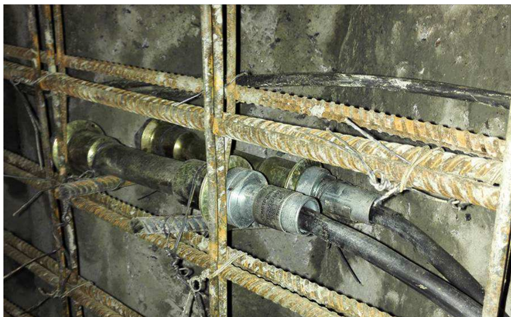
Рис. 3. – Тензометры струнные ТБ-200 (датчики), устанавливаемые во временную и постоянную обделку стволов
